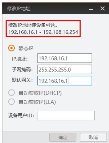
图2-6 修改 IP 地址
