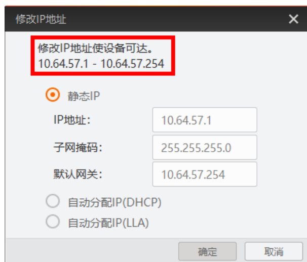
图2-6 修改 IP 地址
