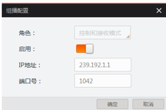
图7-21 连接状态下的相机组播设置
