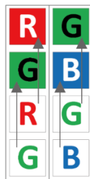
图11-17 彩色相机垂直 Binning 设置为 2
