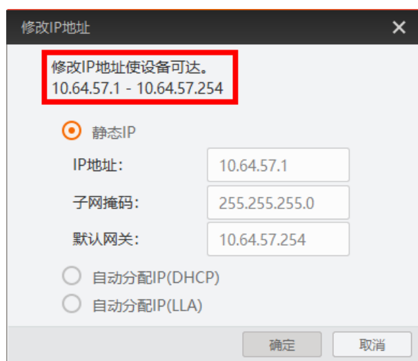
图3-6 修改 IP 地址
