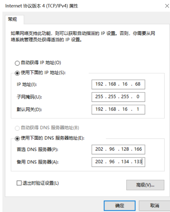
图3-3 PC 网口 IP 配置
