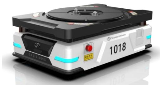
OASIS 600C/SRL 背负移动机器人以Oasis 600C工业搬运机器人底盘为基础，采用激光Slam导航技术，具有环境地图构建、自主路径规划、安全避障、自动充电等功能。相比于Oasis600UL，采用双雷达导航，实现360°的雷达避障，机器人整体三维尺寸均有所减小，整机高度只有280mm，宽度减少为630mm。
