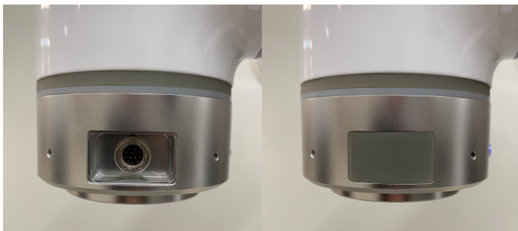
图 3-6：Tool I/O 插头的位置
