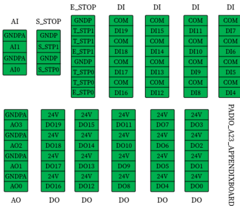
图 7-2：控制箱内部电气接口布局
