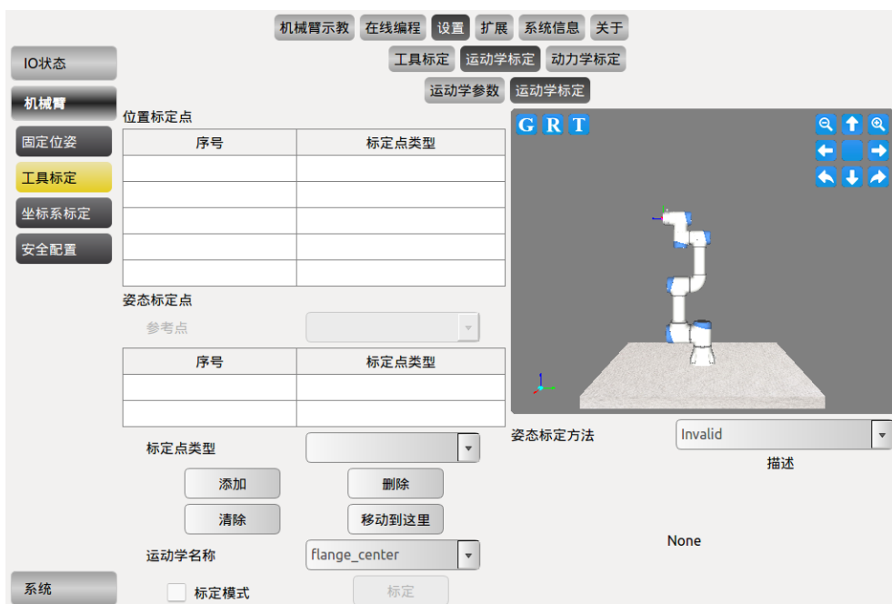
图 10-28 运动学工具标定
