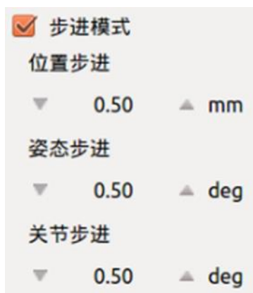
图 10-8 步进模式示意图
