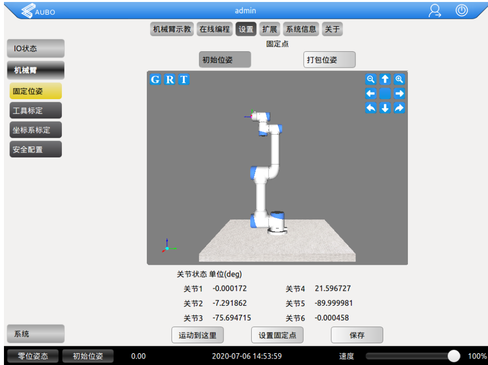
图 10-27 机器人初始位姿设置
