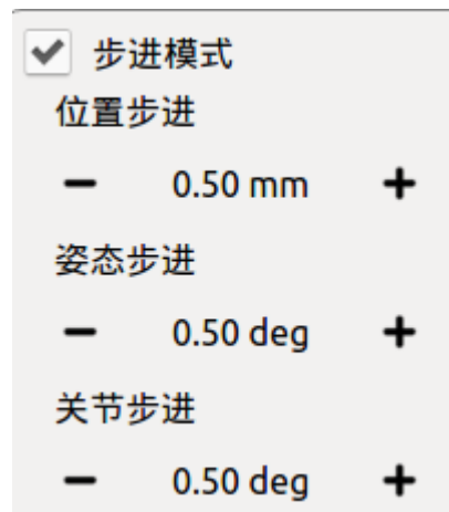
图 10-8 步进模式示意图
