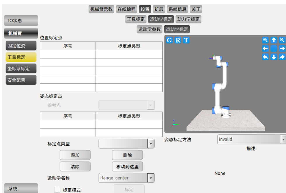
图 10-28 运动学工具标定
