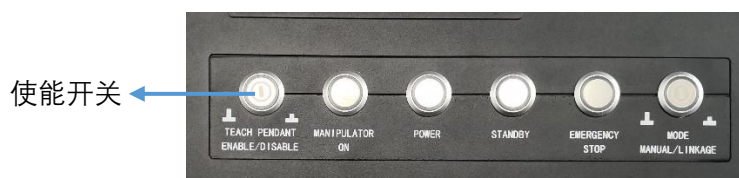
图 7-6 示教器使能开关位置
