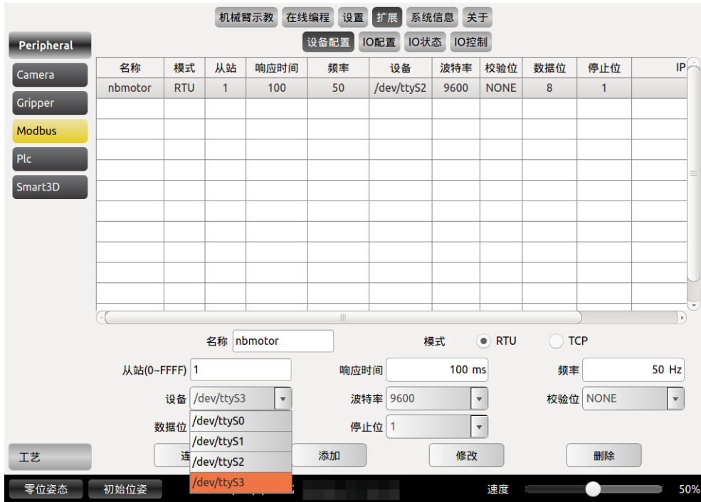
图 10-59 Modbus 设备配置
