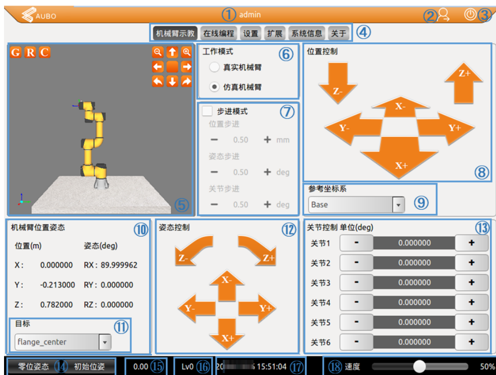
图 10-4 机器人示教面板示意图
