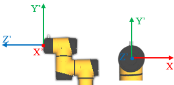
图 10-12 末端坐标系(flange_center)
