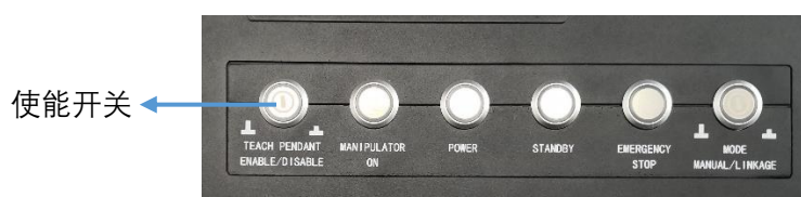
图 7-6 示教器使能开关位置
