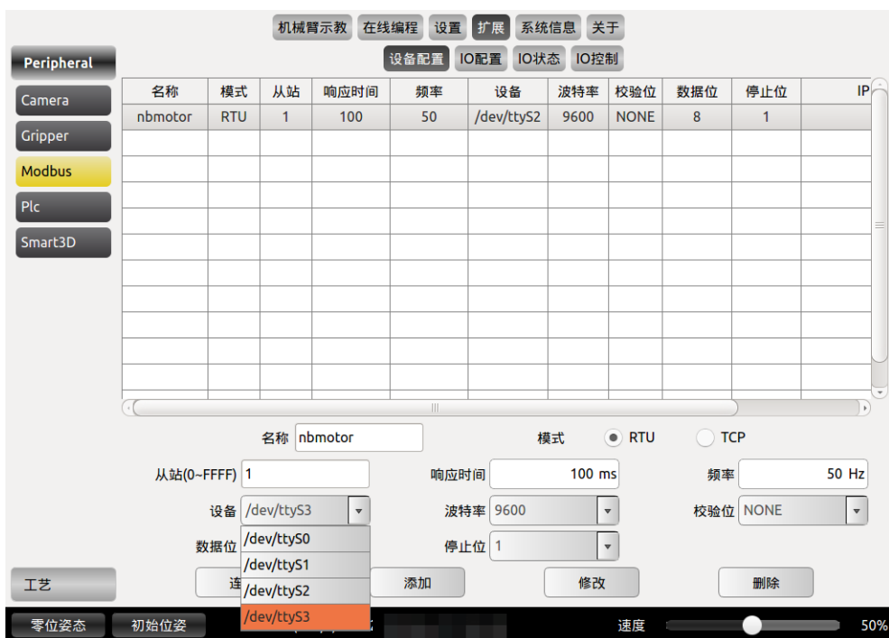
图 10-59 Modbus 设备配置
