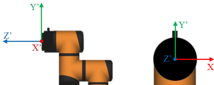
图 10-12 末端坐标系(flange_center)
