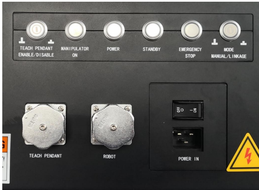
图 7-2 控制柜前面板示意图
