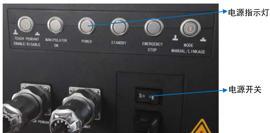
图 9-1 控制柜电源开关及指示灯示意图
