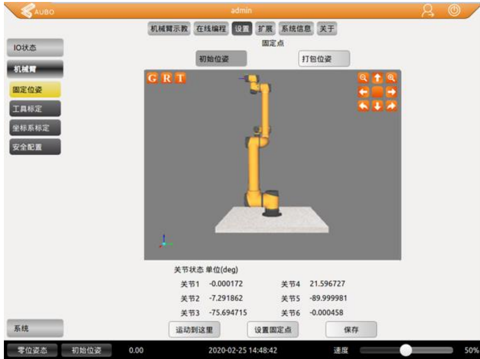
图 10-27 机器人初始位姿设置
