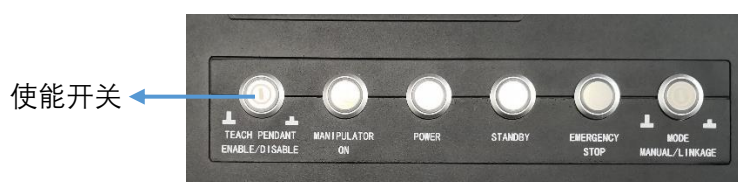
图 7-6 示教器使能开关位置
