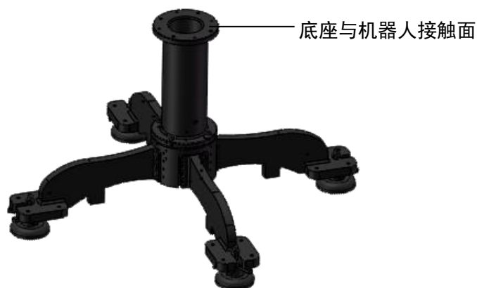
图 6-3 底座结构示意图
