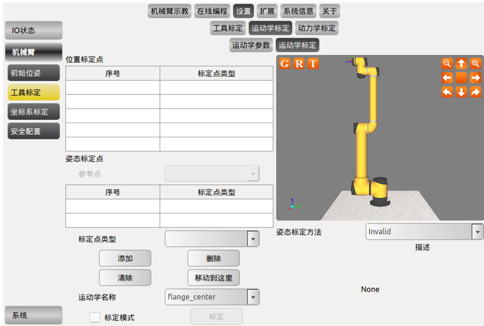
图 10-28 运动学工具标定
