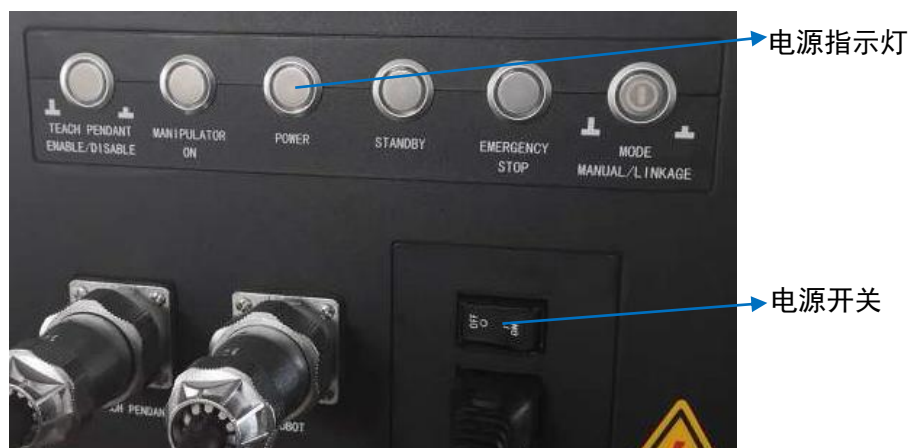
图 9-1 控制柜电源开关及指示灯示意图
