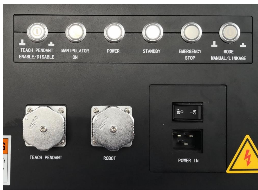
图 7-2 控制柜前面板示意图
