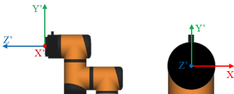
图 10-12 末端坐标系(flange_center)
