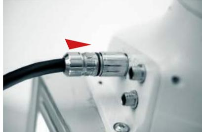
连接臂架和控制装置
