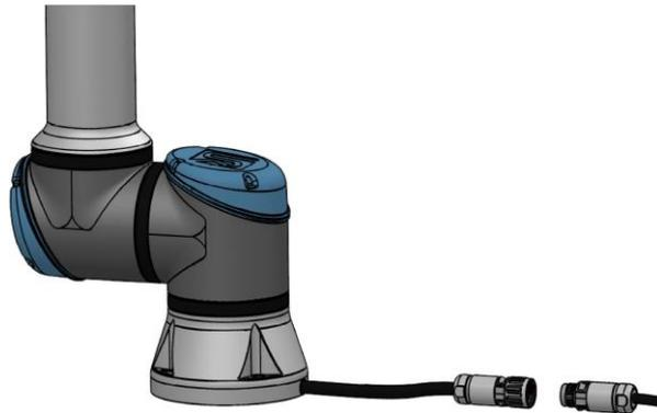
6. 将新的机器人电缆连接到控制箱连接器上，并扭转至闭合位置
