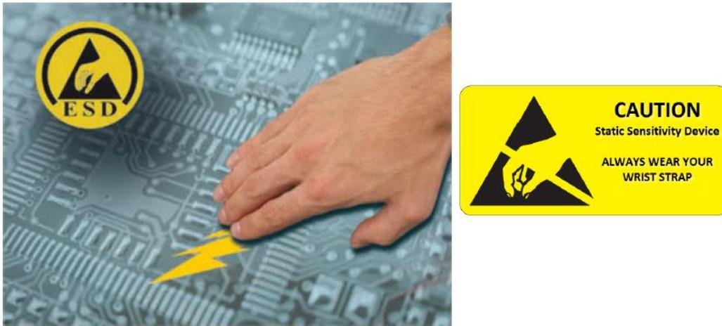
为保护易受静电放电损坏的零件（如印刷电路板）不受损坏，除了采取所有常规的预防措施外，还要遵照以下说明操作，例如，在拆除电路板之前关闭电源。参见完整的[重启序列](#)章节
