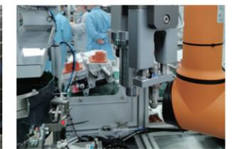
汽车电子控制系统橡胶扣装配
