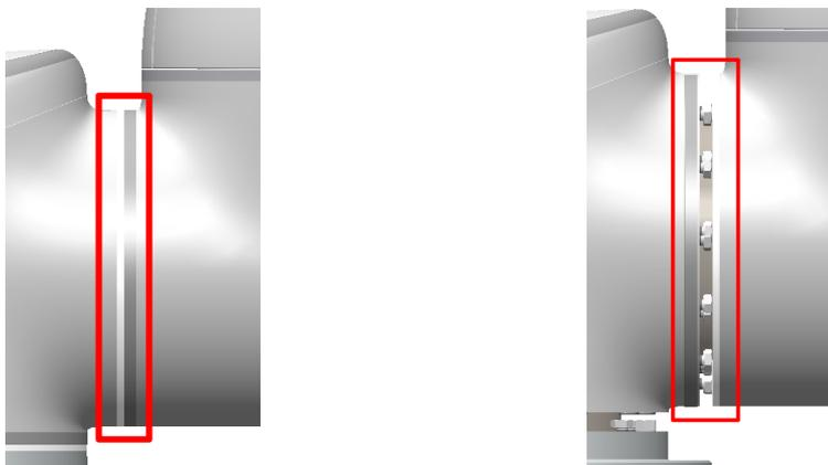
10. 将白色的过渡环向后滑动，10 个螺钉可见，关节两侧各 5 个，使用开口扳手松开螺钉，每个大概两整圈。
