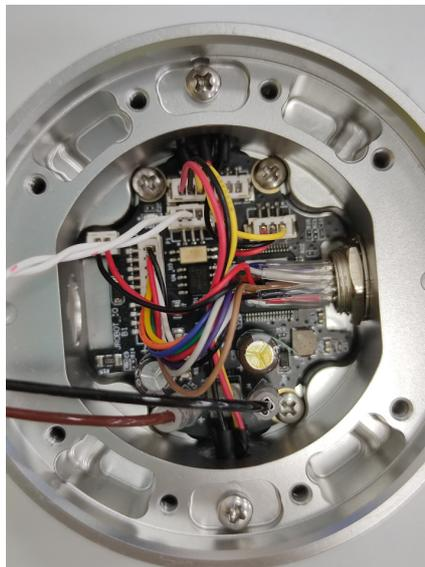
图 1-24：连接手腕 3 关节和末端法兰的电线
