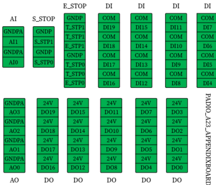
图 7-2：控制箱内部电气接口布局
