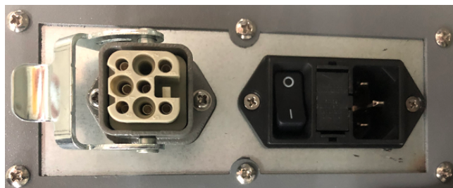
图 5-2：控制箱底部开关电源
