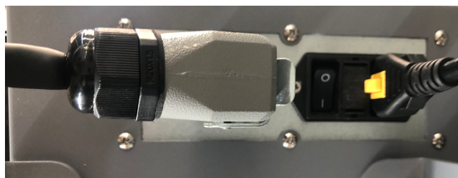
图 5-4：机器人线缆与控制箱的连接
