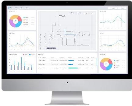
FMS 集群机器人调度系统负责对物流机器人进行任务分配、调度以及数据统计，系统搭载了多种任务调度算法，可根据实际需求灵活配置，以到达最优的任务分配。高效的多机器人路径规划以及交通管制算法，能够让机器人集群能够协同工作，互相合作又互不影响，发挥出整体最大的效能。
