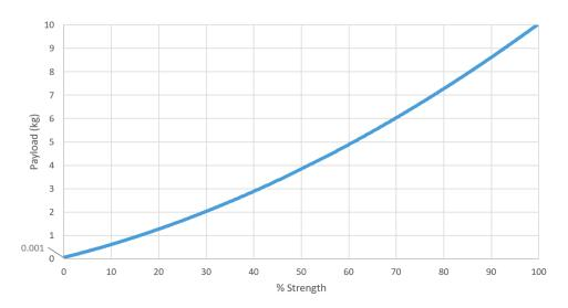
夹爪可以拉动的强度会受到夹爪抓指和工件的方向和不同属性的影响,会产生影响的属性包括 材料类型、厚度、重量、几何形状、表面处理方式等。
