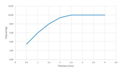
下图显示了在使用 3G 的最大加速度时,气隙距离对夹爪可以抓取并保持工件的最大有效载荷可能产生的影响。
