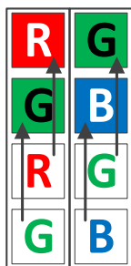
图 8-33 彩色相机垂直 Binning 系数为 2
