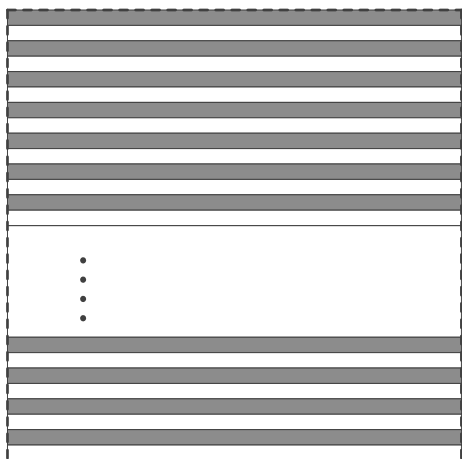
图 8-36 黑白相机垂直像素抽样原理
