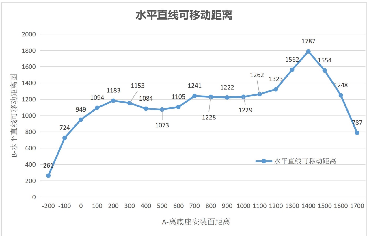
图 2.18 BRTIRUS1510A（10 版本）水平直线可移动距离图
