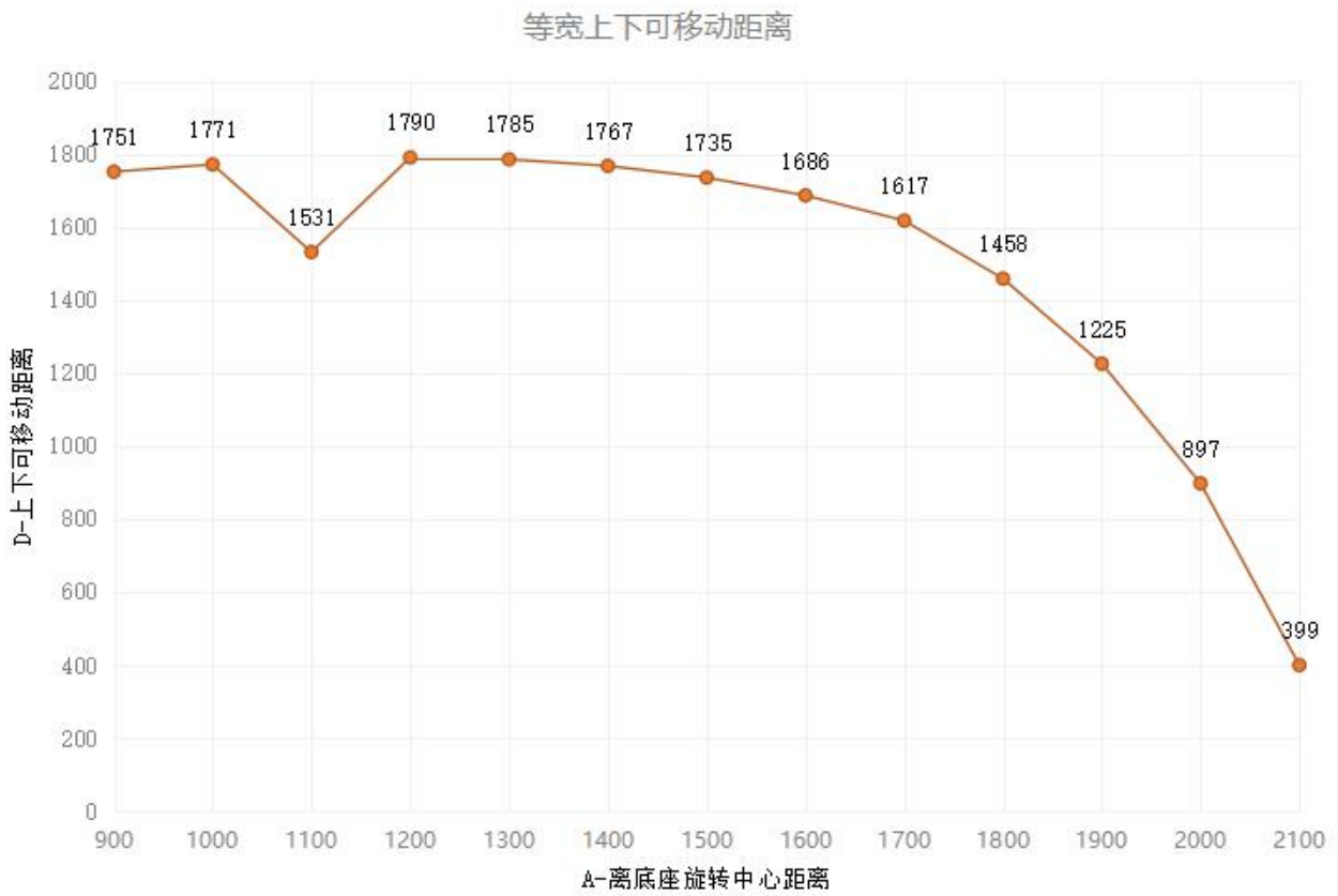
图 2.31 BRTIRPZ2250A 垂直直线可移动距离图
