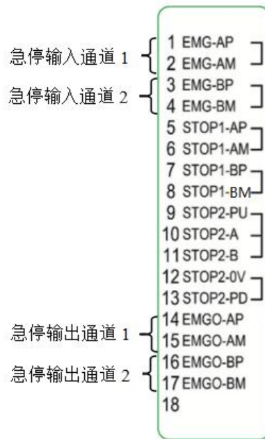
图 3-10 X13 急停功能接线图
