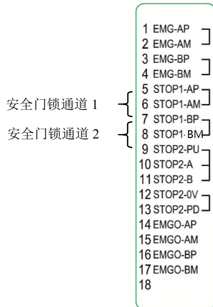
图 3-12 X13 安全门锁接线图
