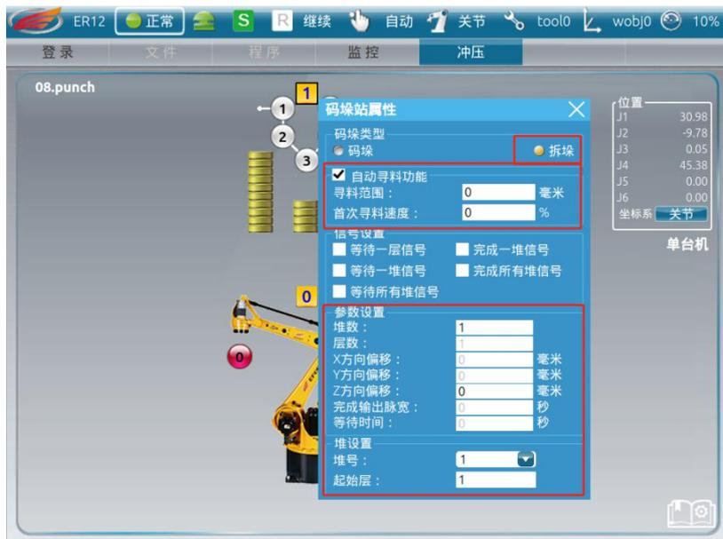
图 18-22 拆垛自动寻料参数设置界面
