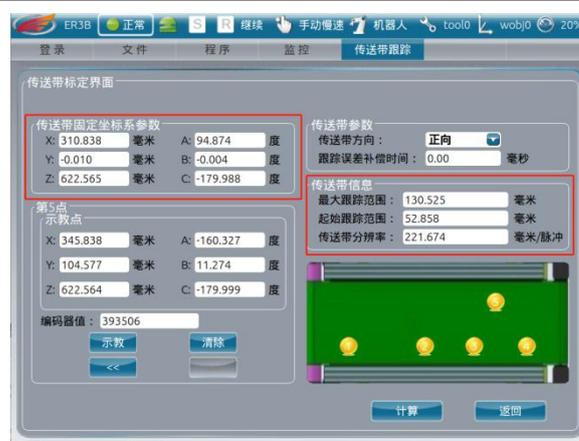
1) 计算成功后，显示传送带固定坐标系参数及传送带信息。
