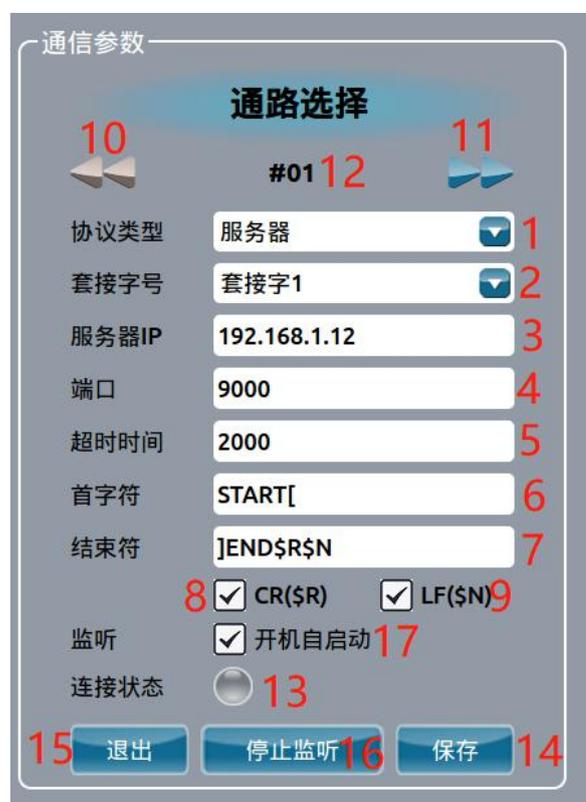
编号 1：协议类型，分为客户端和服务端，选择服务器表示机器人做服务器。
