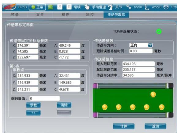
点击“>>”，进行第3点标定，开动传送带运行至第3点位置，将机器人末端工具移动到工件表面上方，点击“示教”，示教成功后，进行第4点标定；开动传送带，运动标定位置4，将机器人移动工件表面上方，点击“示教”，示教成功后，进行第5点标定；开动传送带，运动标定位置4，将机器人移动工件表面上方，点击“示教”，示教成功后，进行第6点标定；将工件放到传送带Y方向的某个位置，点击“示教”。
