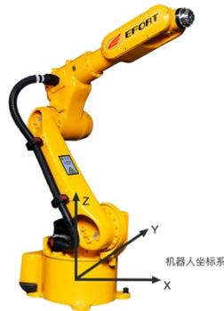
图 4-2 机器人坐标系图示
