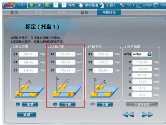
机器人抓取产品状态，将末端工具平移到托盘上定义的一个 x 轴上相邻顶点。
