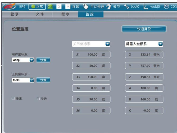
图 4-8 机器人坐标系下位置监控界面
