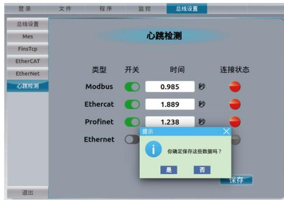
通过检测心跳值有没有改变来判断通讯的连接状态是否断开，连接状态的显示呈灰色时表示未连接，红色表示连接失败，绿色表示连接成功。
