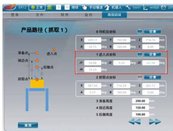
如界面左侧图示，将机器人末端夹爪移动至一个进入点，点击“记录”按钮。
