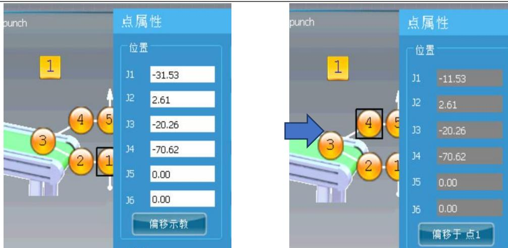
b 参考点“1”修改后基于参考点1的偏移点“4”的位置
