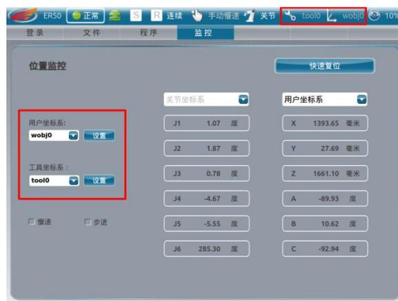
左边的工具/用户坐标系选择框，可以选择不同的工具/用户坐标系，点击设置，则将选择的坐标系激活。
