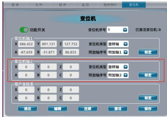
双轴变位机的标定只需要配置好变位机类型和附加轴序号，然后点击对应“标定”按钮。
