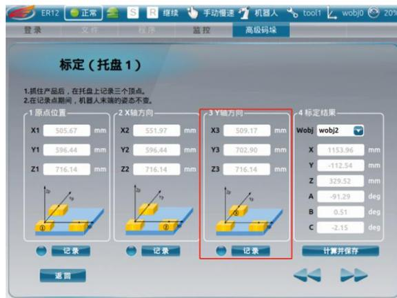
机器人抓取产品状态，将末端工具平移到托盘上定义的一个 y 轴上相邻顶点。
