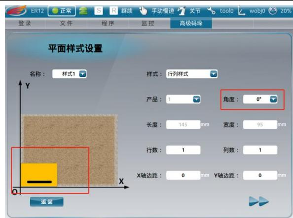
点击角度下拉框，选择产品旋转的角度，则在左边的托盘上产品根据角度进行旋转。
