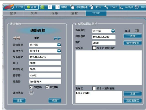
2. 获得管理员权限后，在通讯参数设置栏菜单下可以设置协议类型、套接字号、服务器 IP、端口号、超时时间、首字符、结束符设置参数。填写完后，点击“保存”按钮，完成参数保存。
