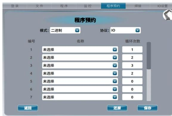
模式分为：单独和二进制。单独模式通过 4 个输入端口分别可以关联 4 个示教文件。二进制模式通过 4 个输入端口的二进制组合最多可以关联 15 个示教文件。详细信息见程序预约 IO 口配置中相关说明。
