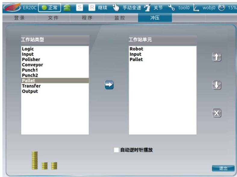
图 18-16 加载码垛单元
