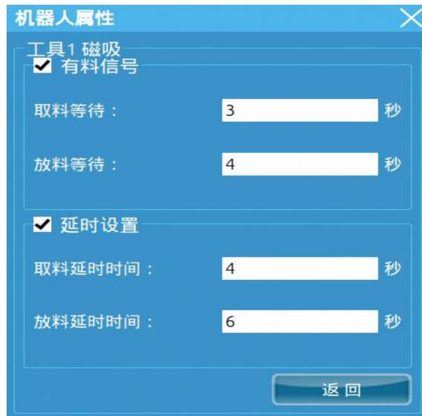
图 18-13 工具抓取操作设置
