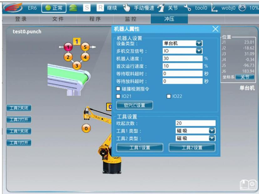
13.添加点，每个工作站内的机器人路径都已经默认配置了5个点或9个点。如果需要添加在工作站之间的过渡点，那么点击工作站中的黄色圆形标号
