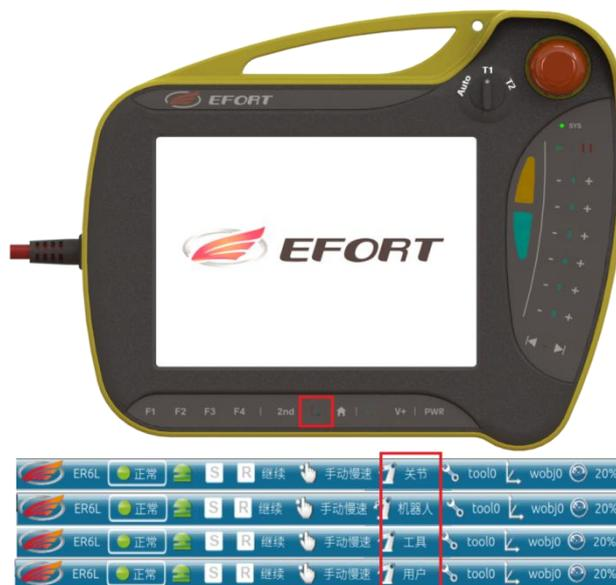
图 4-6 坐标系切换和不同坐标系图标
