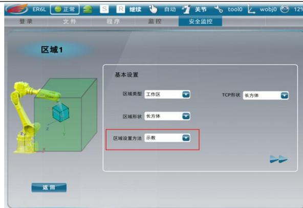
示教方法的基本设置与编辑方法相同，将区域设置方法的下拉框选择为“示教”。
