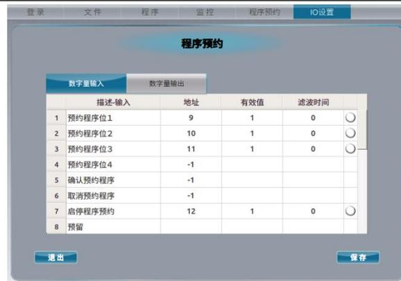
如图所示，配置三个程序对应的 IO 口，未使用的可以不配置。
