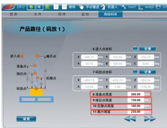
码放点向上运动一个高度即为准备点，点击编辑框设置一个高度值。
