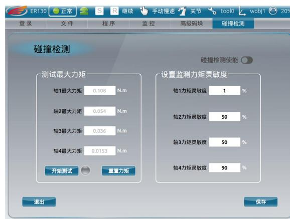
点击“完成测试”按钮后，按钮右侧指示灯处于灰色状态，表示完成测试，按钮变为“开始测试”。
