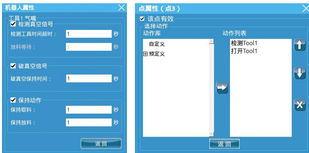
8.设置动作，该页面用于工具夹具的动作，无论单元中有几个工具，每个工具有几个动作，都可以在该页面分别设置。
