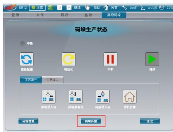
在生产状态界面点击“码垛补偿”按钮进入码垛信息界面。
