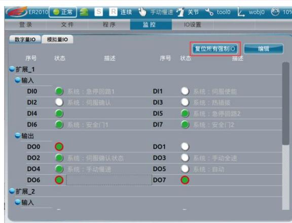
点击“复位所有强制 IO”可以将强制操作的状态恢复到操作之前。
