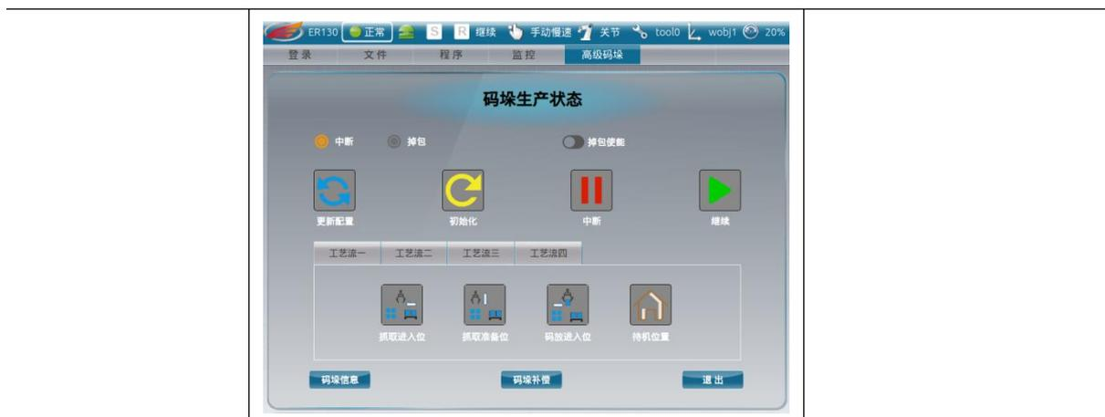
2.使用生产状态界面上的快捷键，若存在两个垛位则可以分别使用两个工艺流程的快捷键，以工艺流一为例进行说明。
