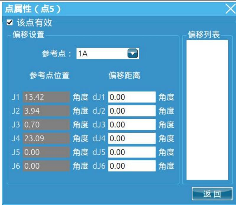
在“点偏移”界面中, 参考下拉菜单中选择需要参考的点。在“点属性”下部左侧参考点位置中, 显示的是所选中的参考点的位置, 右侧“偏移距离”可以设置偏移距离或角度。
