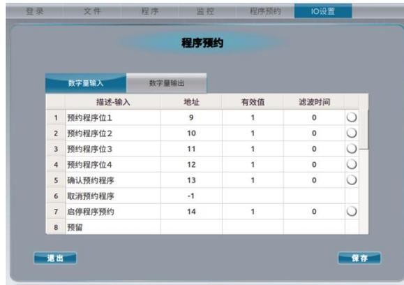
如图所示，配置四个程序对应的 IO 口。
