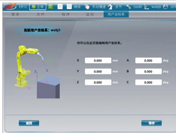
在白色的编辑框中输入工具坐标系的数值。
