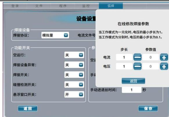
在线修改是指在焊接过程中，修改焊接参数，现在支持修改电流和电压参数。
