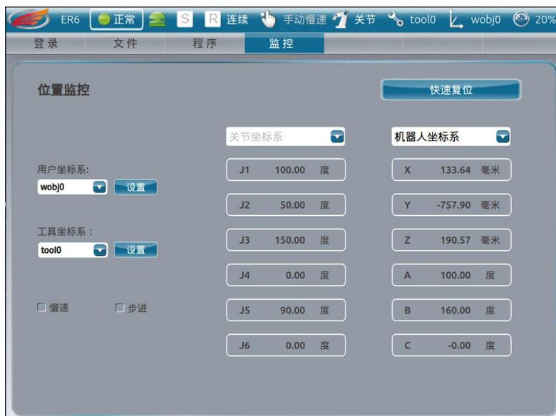
图 4-9 工具坐标系下位置监控界面
