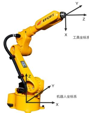
图 4-3 工具坐标系图示
