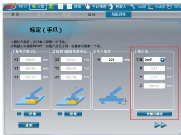
选择工具坐标系中标定好的工具坐标系。
