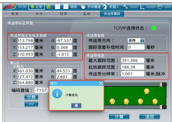
计算成功后，点击提示框上的“是”，计算结果更新在传送带固定坐标系参数和传送带信息中。
