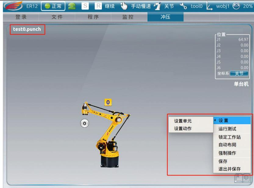
6. 点击
