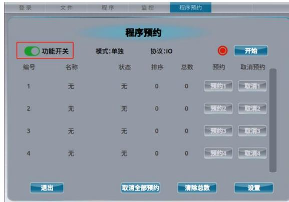
如果程序预约的功能开关处于关闭状态，需要将“功能开关”打开。
