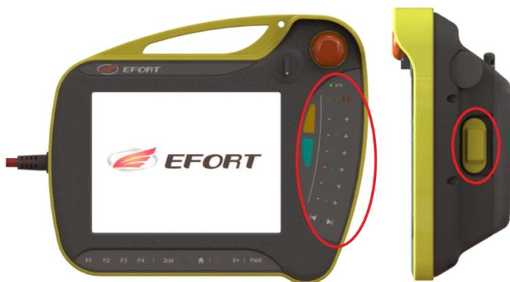
图 4-7 手压开关和点动按钮位置
