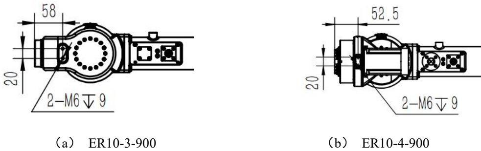
图 2-16 手腕体上安装外部件尺寸图
