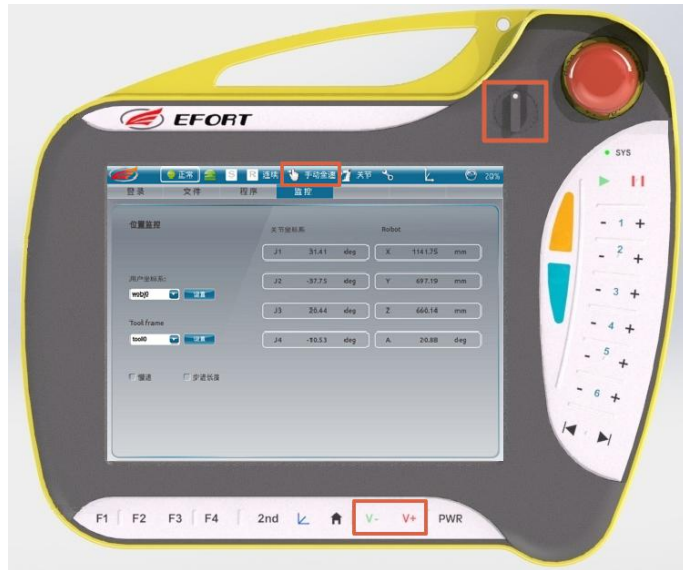
图 4-13 机器人加减速
