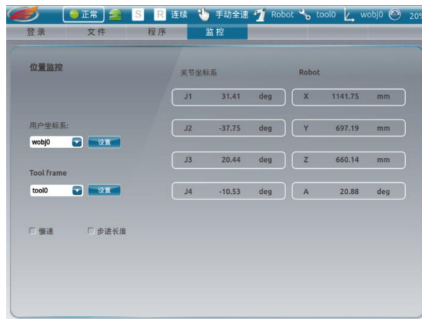
图 4-10 机器人笛卡尔坐标系点动
