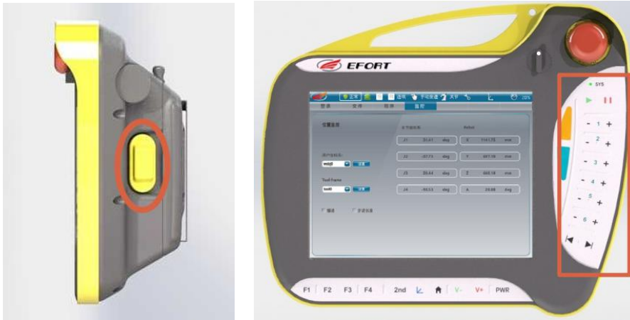
图 4-9 机器人关节坐标系点动
