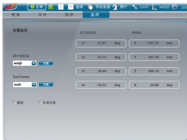
图 4-12 机器人用户坐标系点动
