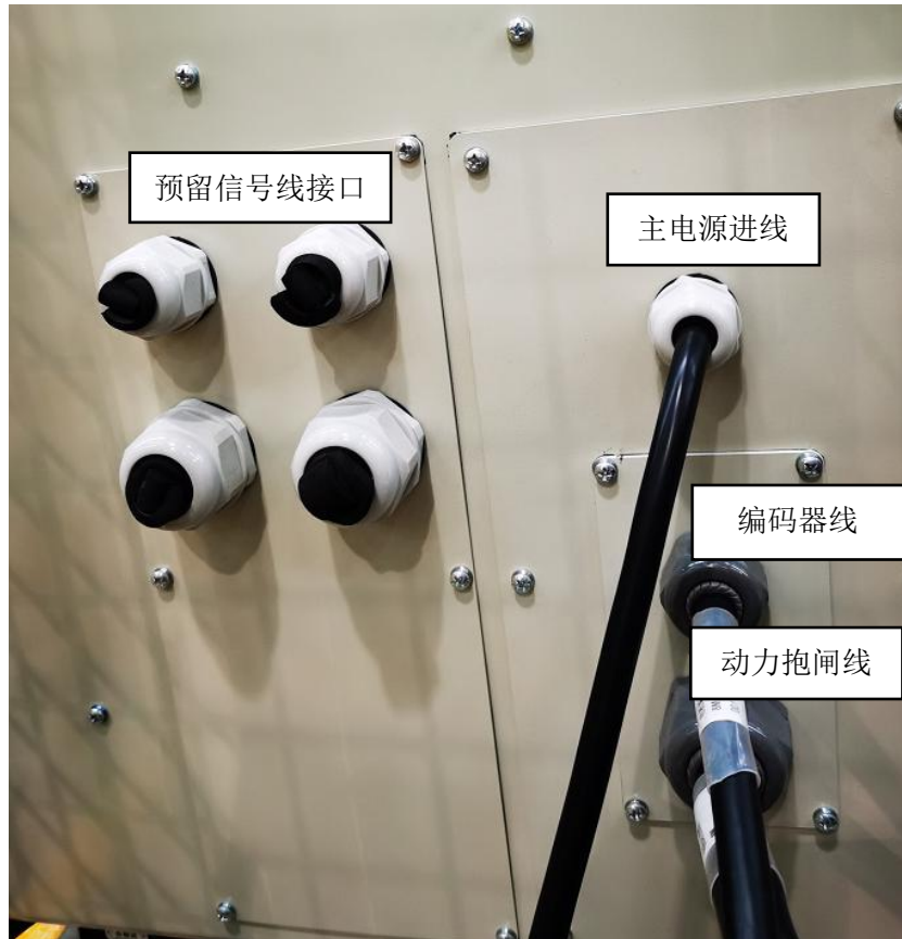
图 3-3 机器人控制柜连接示意图
