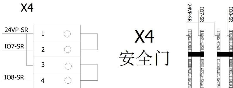
图 3-10 安全门及光栅接线端子示意
