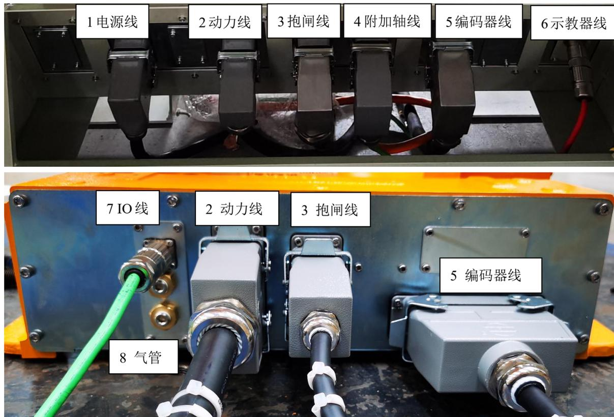
图 3-5 控制柜与本体连接示意图
