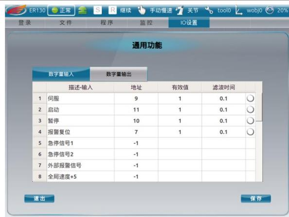
点击“编辑”按钮，将启用编辑功能，编辑模式下不能实时刷新显示 IO 状态。
