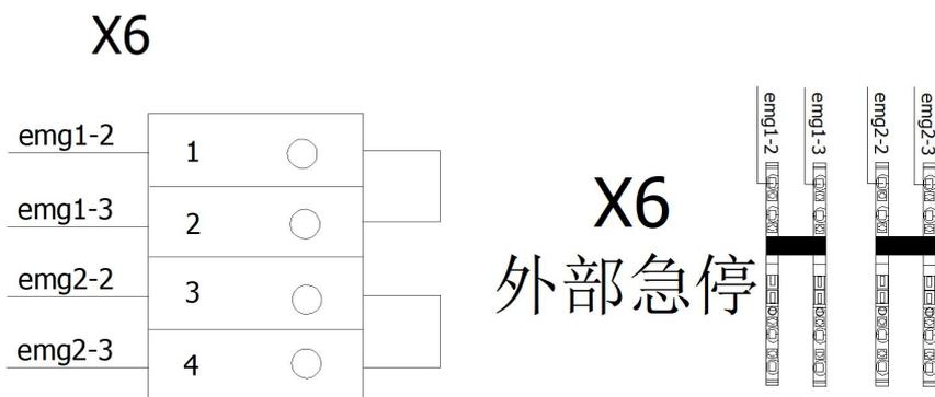
图 3-8 外部急停位置指示及接线原理图
