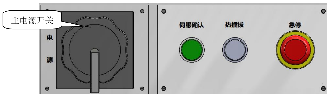
图 4-6 主电源开关位置
