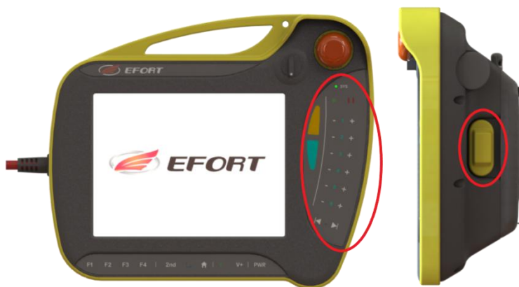
图 4-9 示教器手压及右侧功能键
