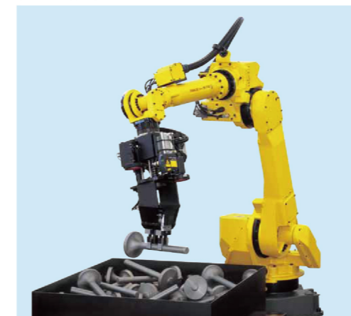
散堆圆柱形工件的拾取
