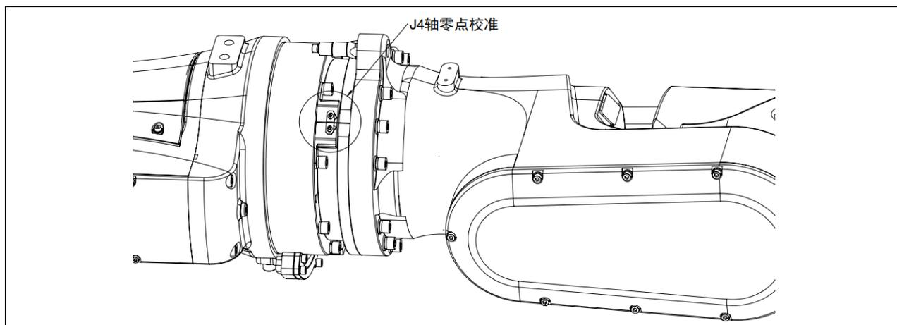
图 6.6 J4 轴校准示意图 (ER80B-2565-BD)
