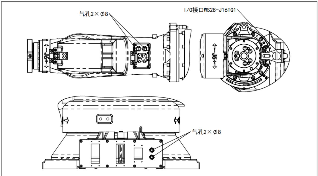
图 4.7 外部管线示意图 (ER80B-2565-BD)
