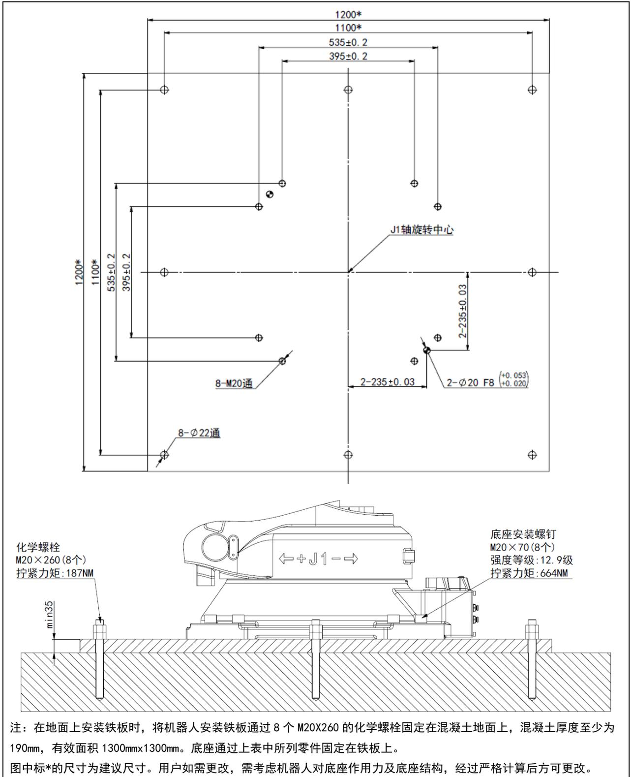
图 1.8 折弯机器人安装铁板尺寸
