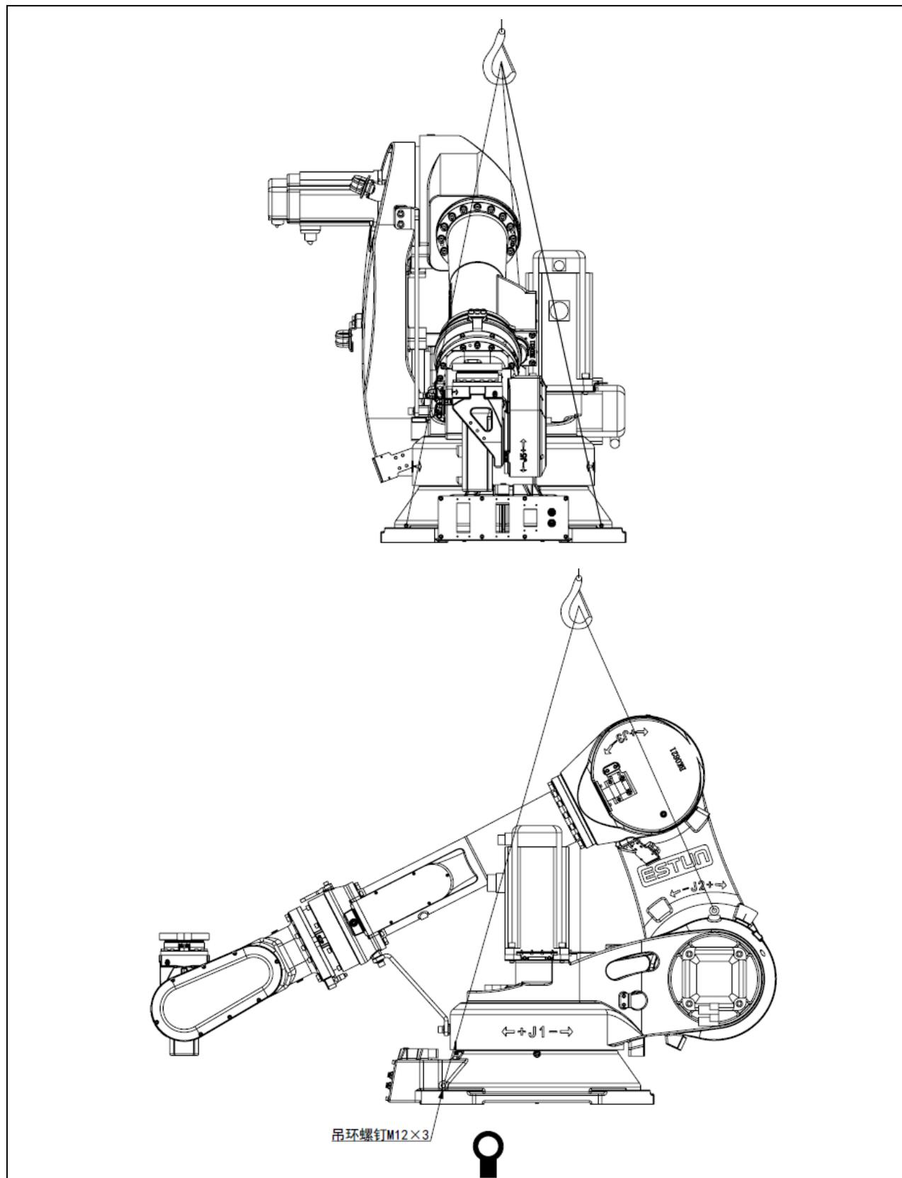
图 1.4 折弯机器人起重机搬运示意图 (ER80-2565-BD, ER80B-2565-BD)
