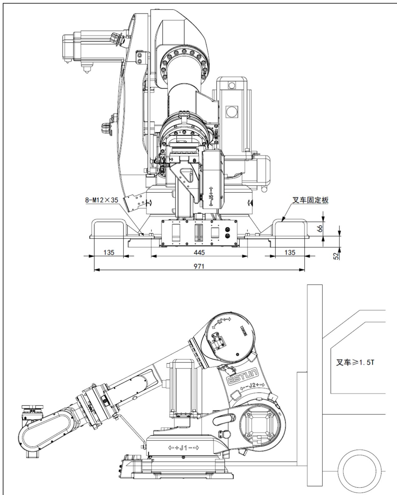
图 1.3 折弯机器人叉车搬运示意图
