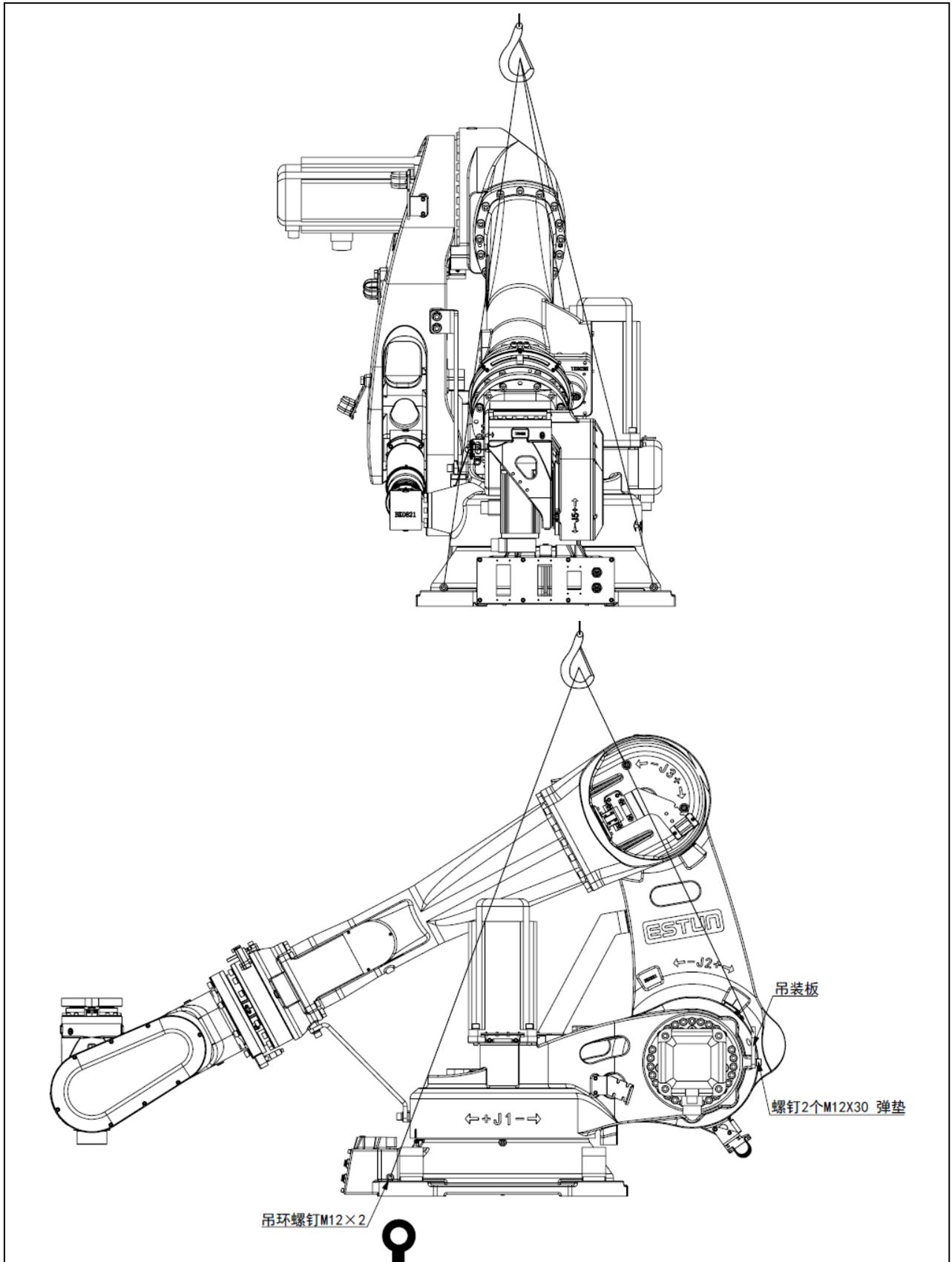
图 1.5 折弯机器人起重机搬运示意图 (ER130-2865-BD)
