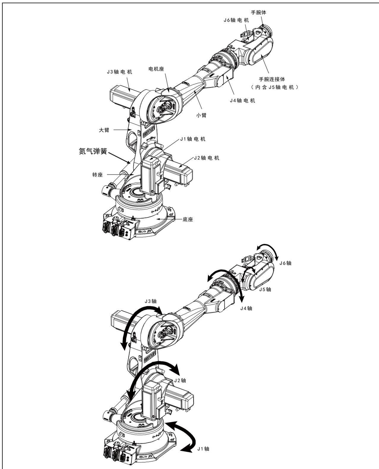
图 3.1 折弯机器人的构成
