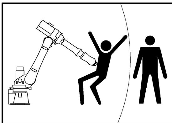
图 0.4 机器人伤人警示标识
