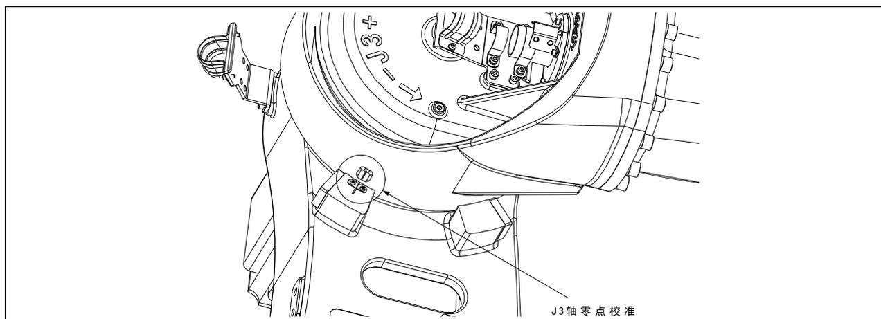
图 6.4 J3 轴校准示意图
