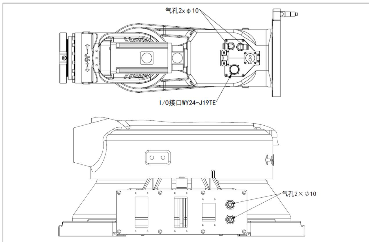
图 4.8 外部管线示意图 (ER130-2865-BD)
