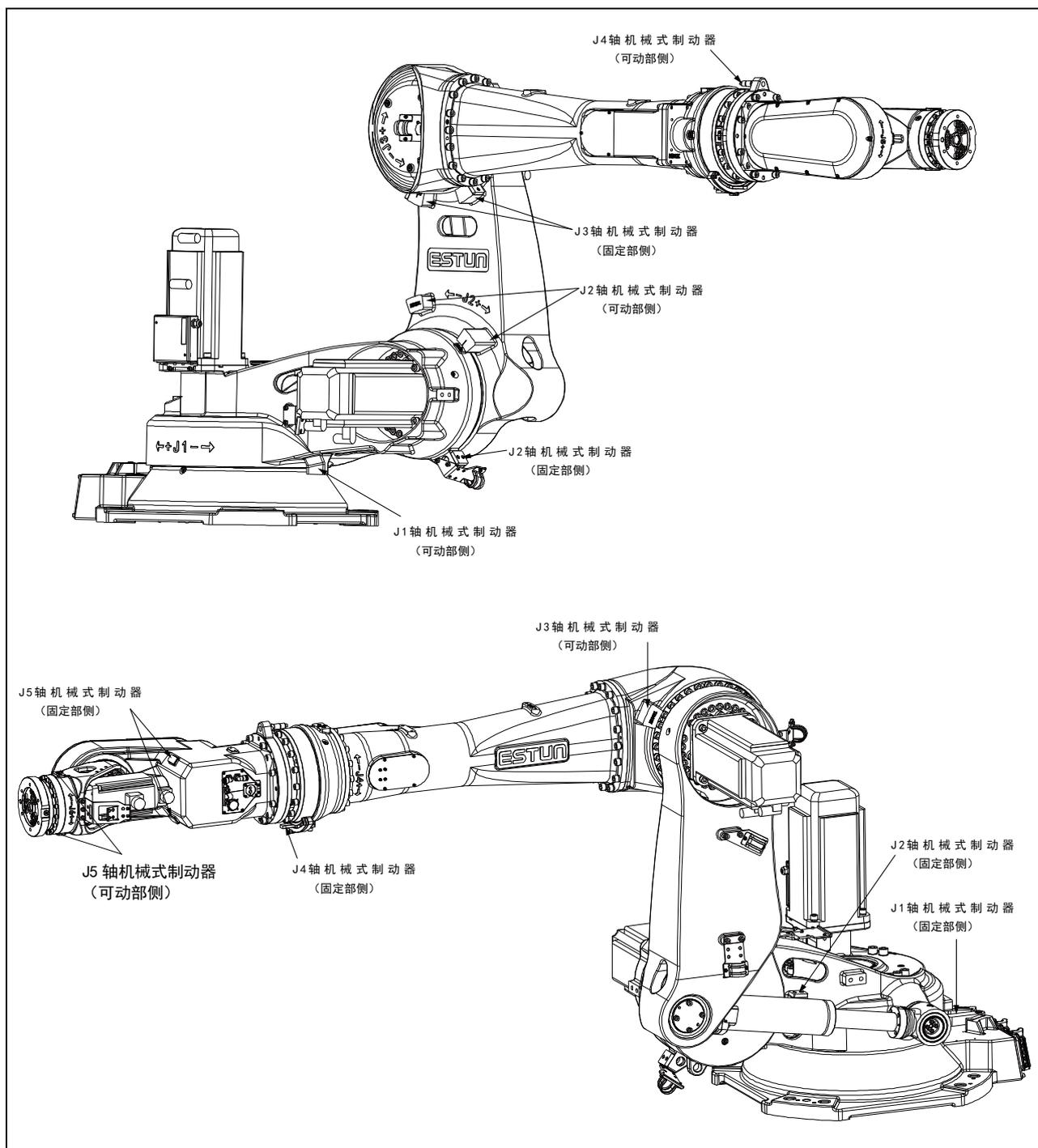
图 3.8 机器人机械式制动器位置 (ER130-2865-BD)
