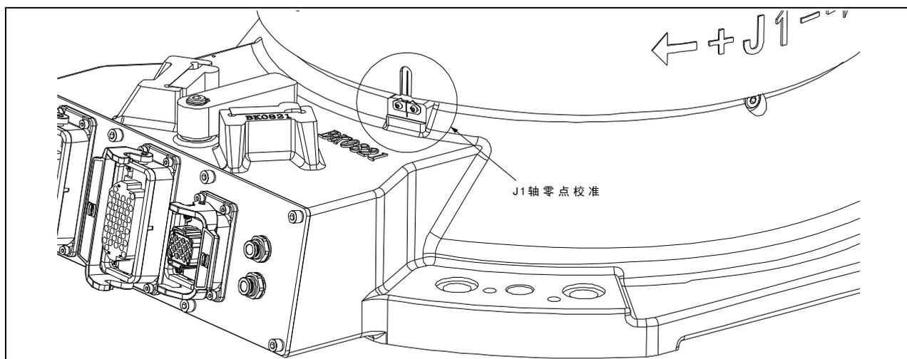
图 6.2 J1 轴零点校准示意图
