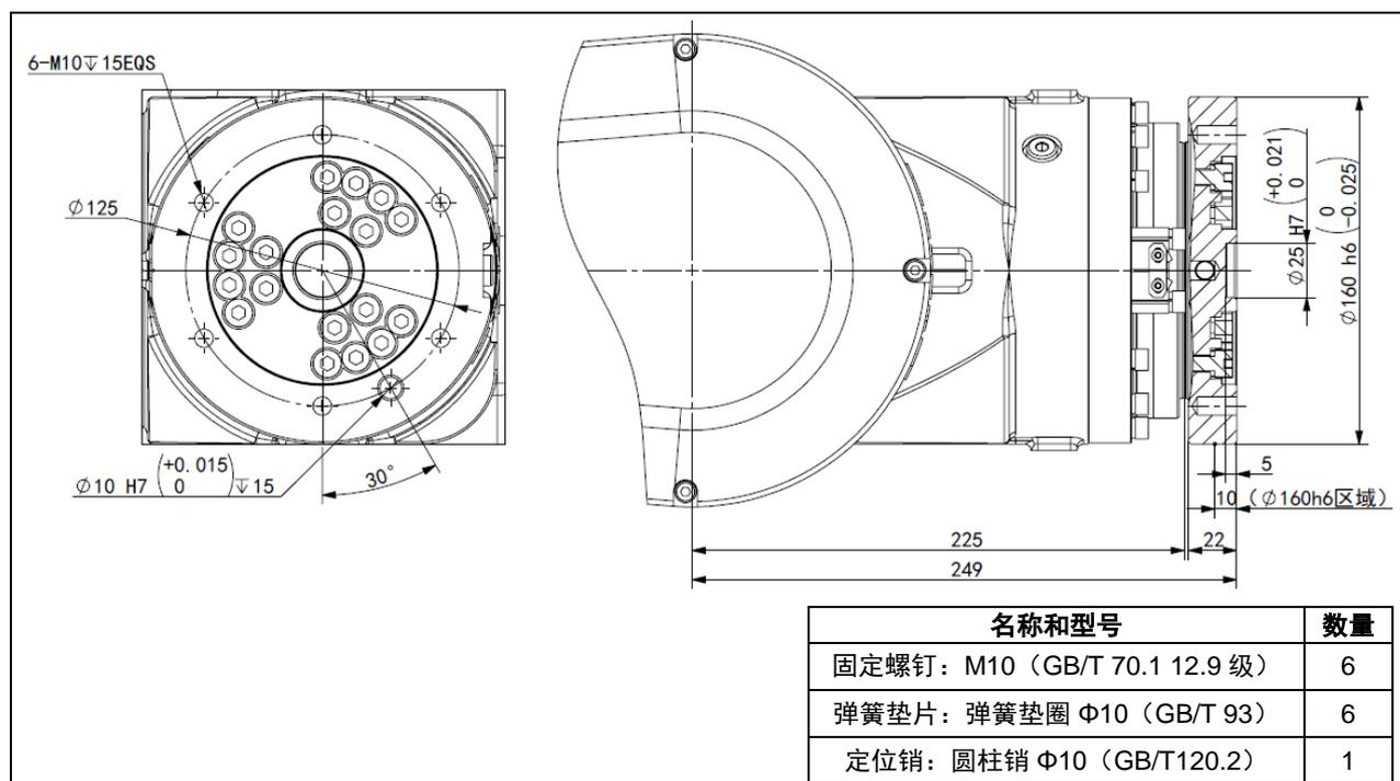
图 4.2 末端法兰安装接口 (ER130-2865-BD)
