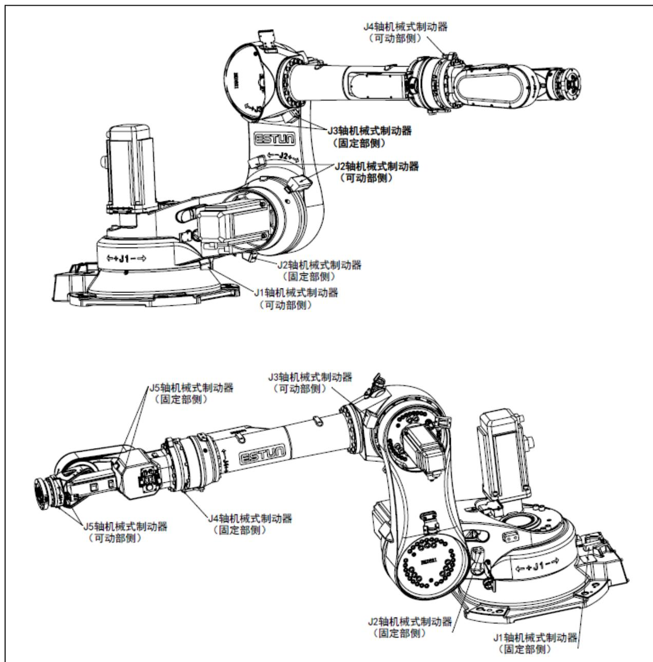
图 3.6 机器人机械式制动器位置 (ER80-2565-BD)
