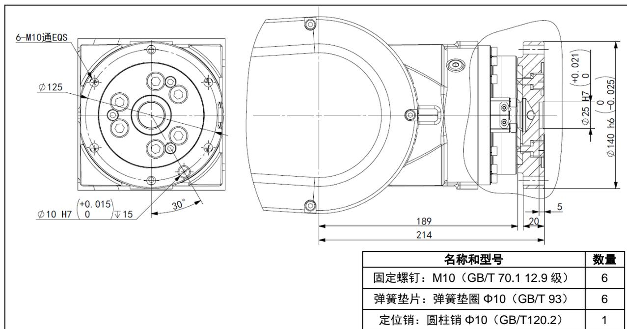
图 4.1 末端法兰安装接口 (ER80-2565-BD, ER80B-2565-BD)
