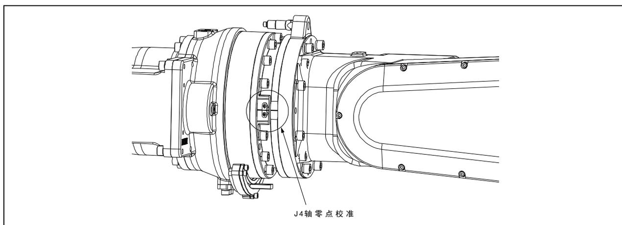
图 6.5 J4 轴校准示意图 (ER80-2565-BD, ER130-2865-BD)
