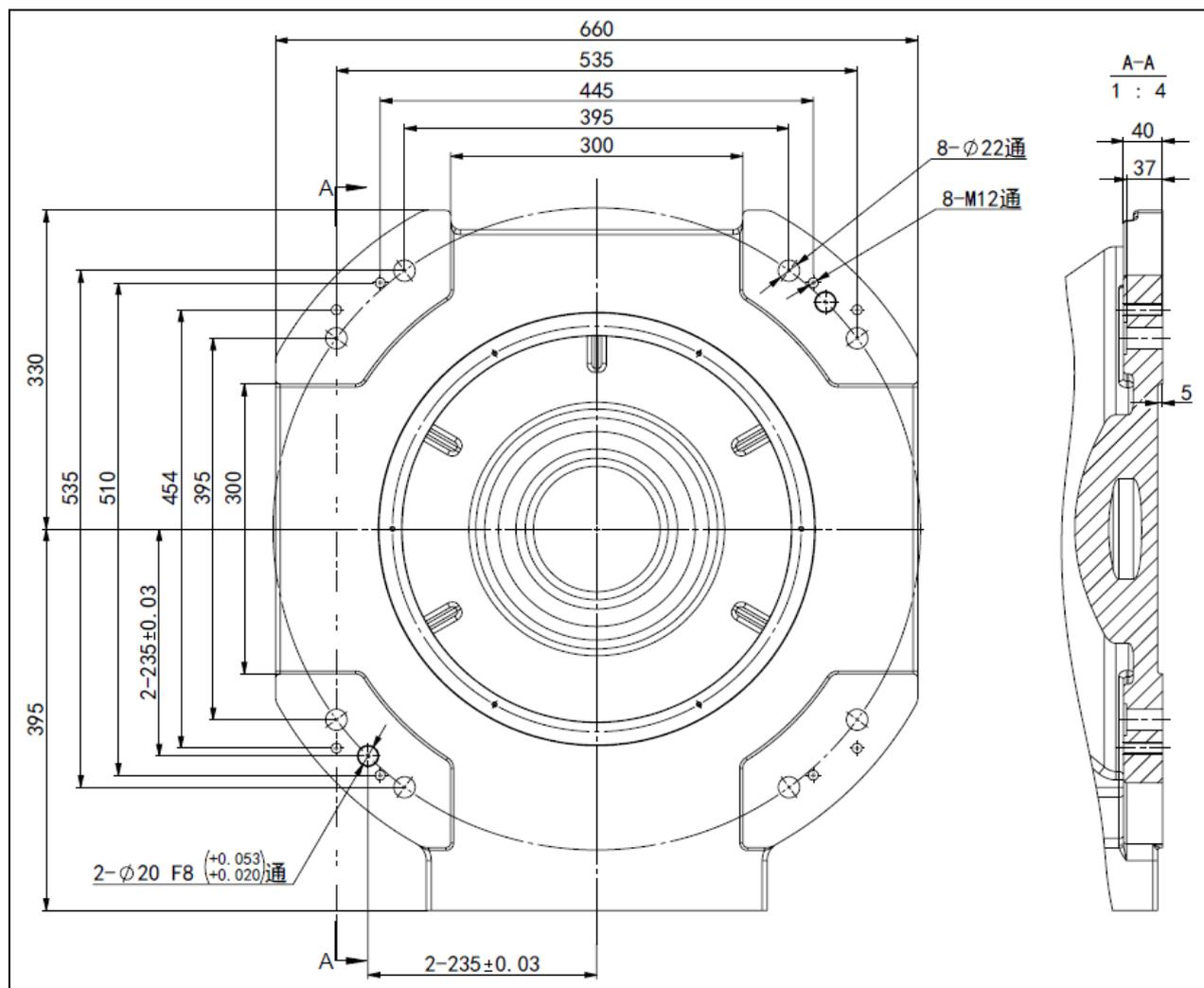
图 1.7 折弯机器人底座安装尺寸
