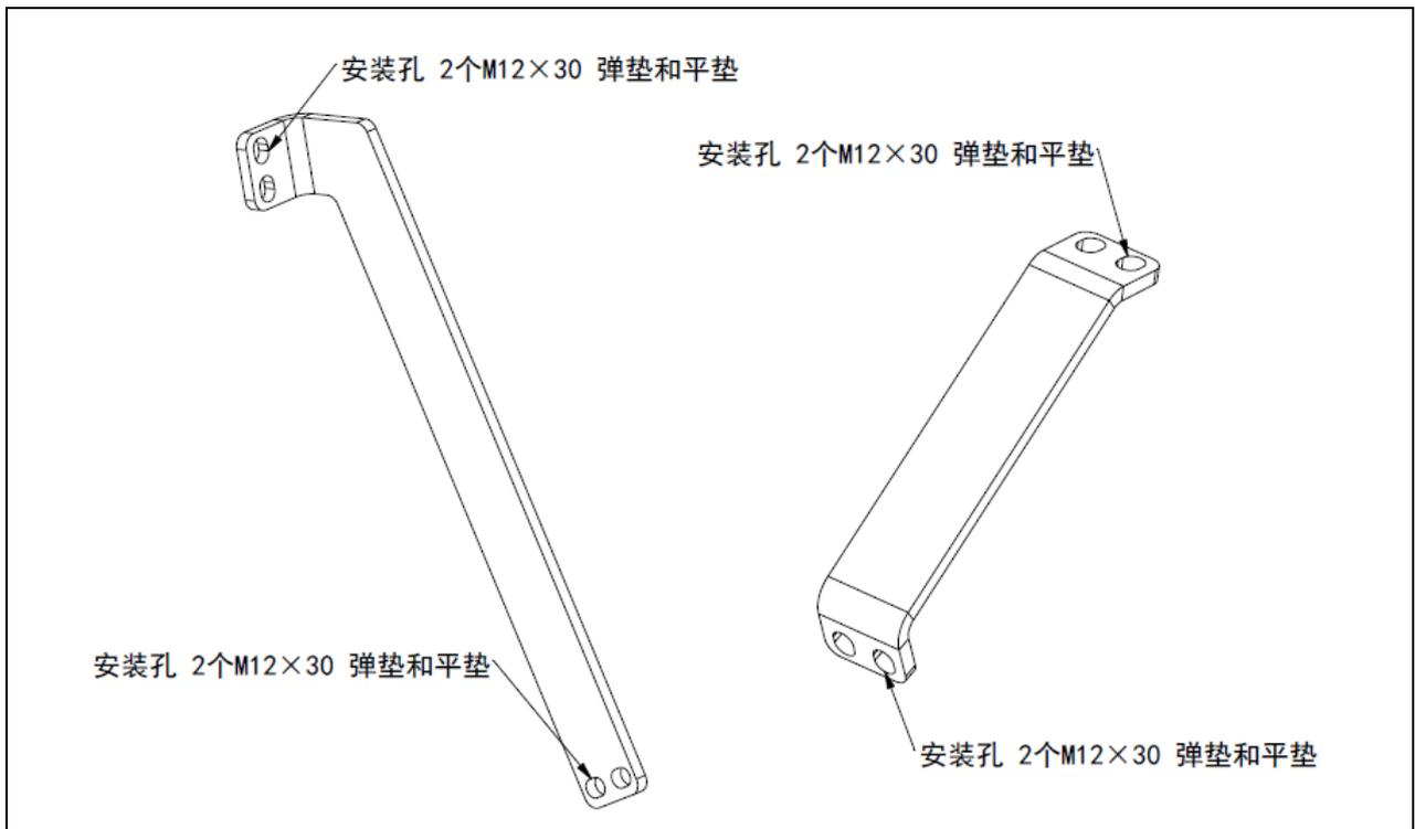
图 1.1 机器人固定支架 (ER80-2565-BD, ER80B-2565-BD)
