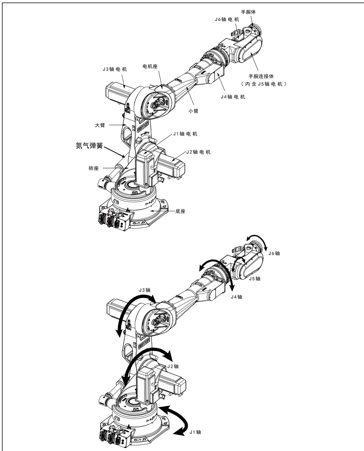
图 3.1 折弯机器人的构成
