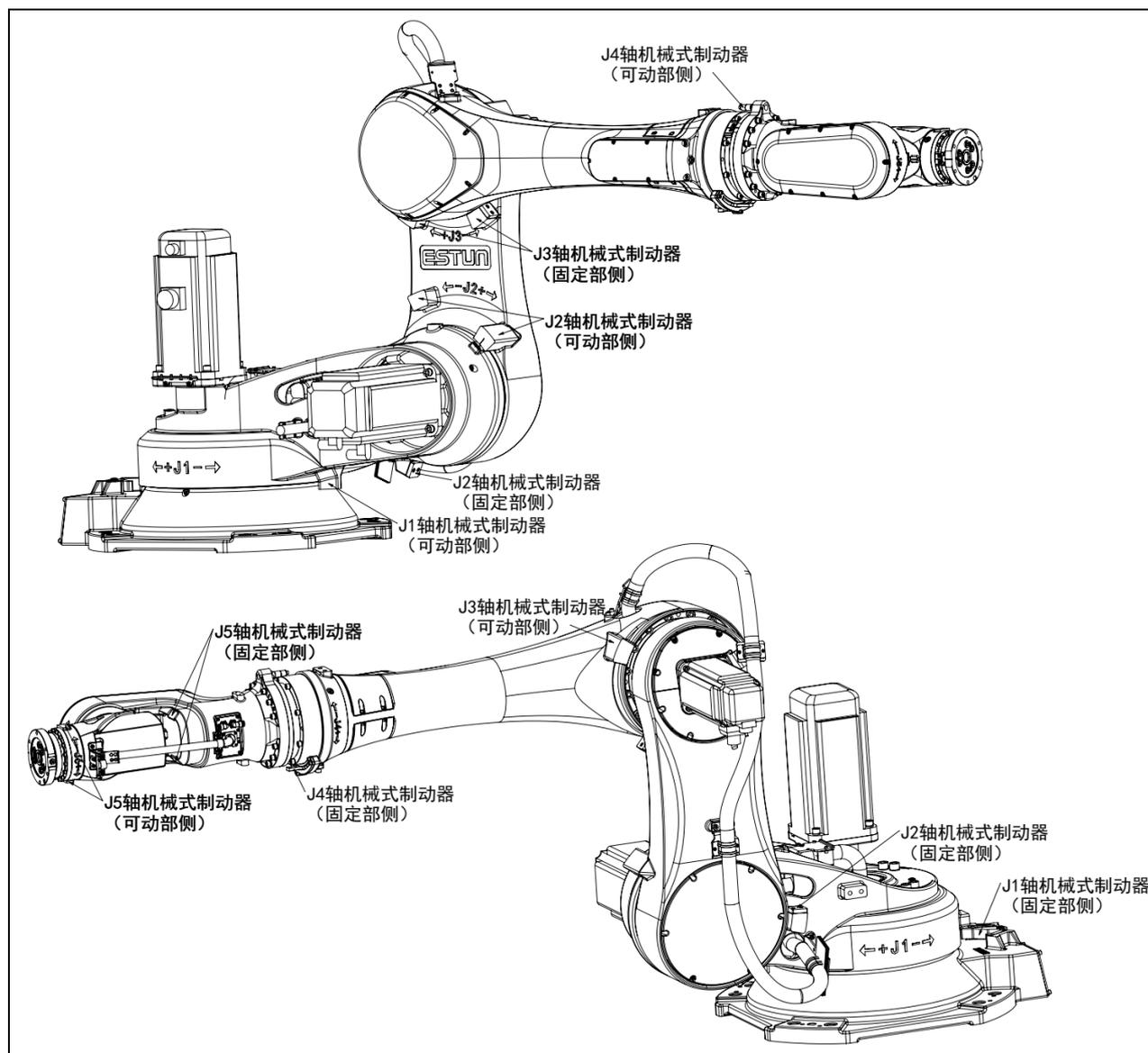
图 3.7 机器人机械式制动器位置 (ER80B-2565-BD)
