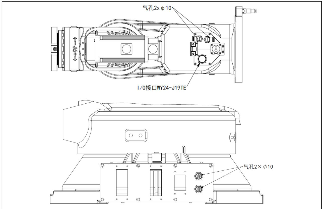
图 4.8 外部管线示意图 (ER130-2865-BD)
