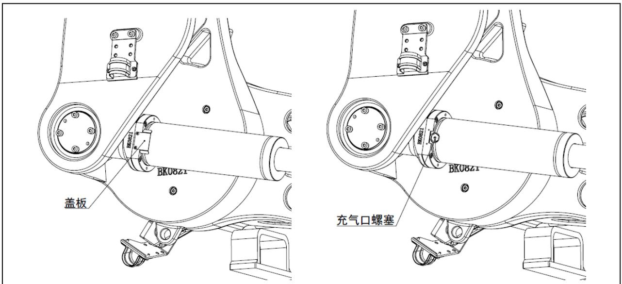
图 5.2 气弹簧检查示意图
