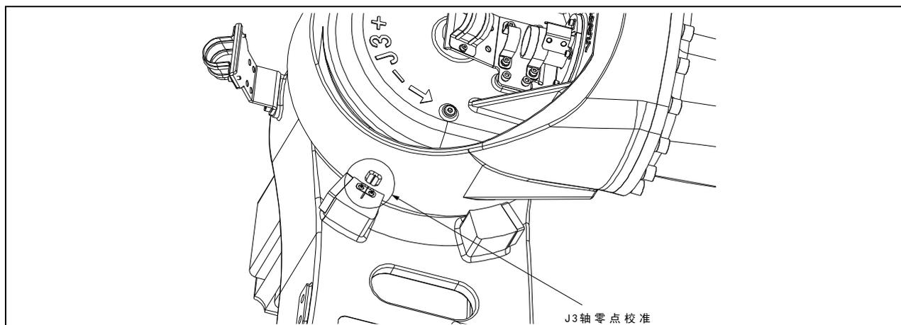
图 6.4 J3 轴校准示意图
