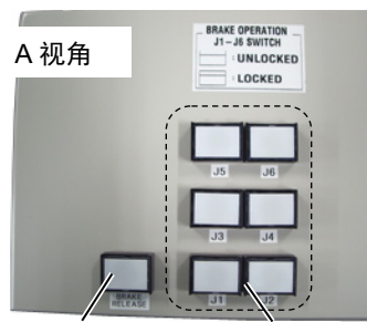
电源指示灯 制动解除开关
