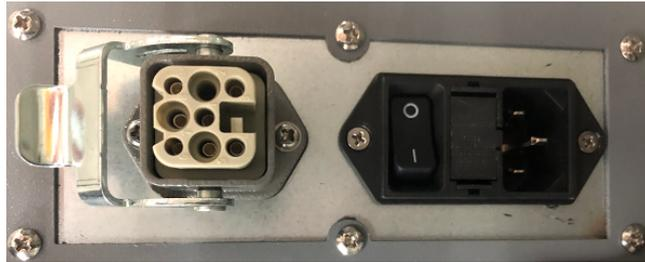
图 5-7：控制箱底部开关电源
