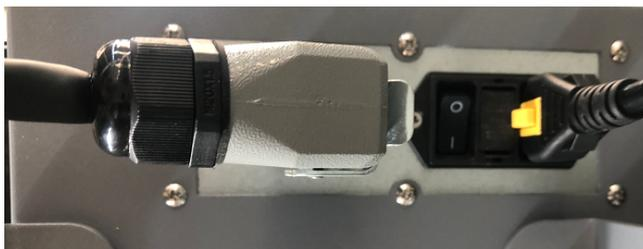
图 5-4：机器人线缆与控制箱的连接
