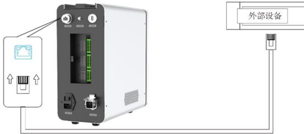
图 3.56 Dobot 机器人控制系统与外部设备直连
