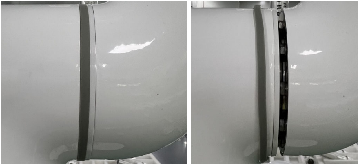
图 3-4：拆橡胶固定环
