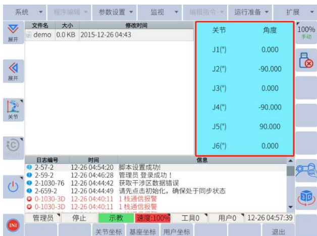
图 6-7：监视区半幅显示
