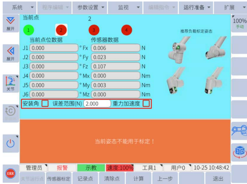
图6-44: 安装角和重力加速度
