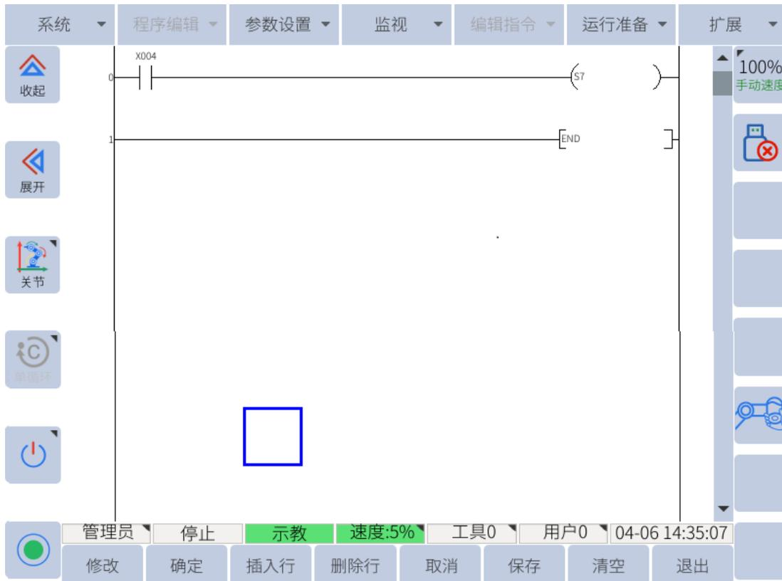
图 10-5 : 关闭伺服的 PLC 示例
