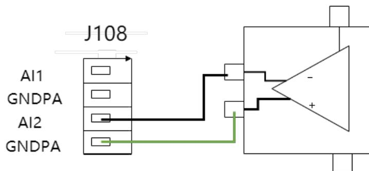
图 7-15: 连接模拟传感器
