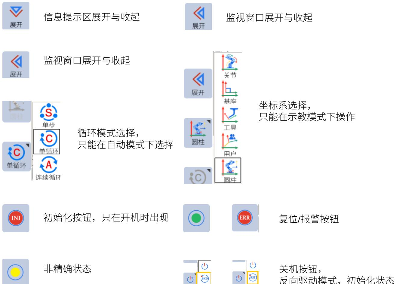
本系统的部分显示画面可全幅显示和半幅显示，点击“展开”键可左右或者上下展开，因此在程序自动运行过程中也可以多画面显示，便于程序的调试。
