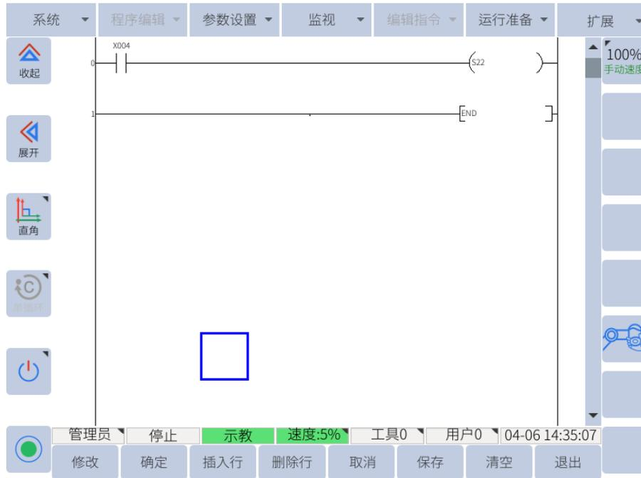
图 10-10: 编码器标定的 PLC 示例
