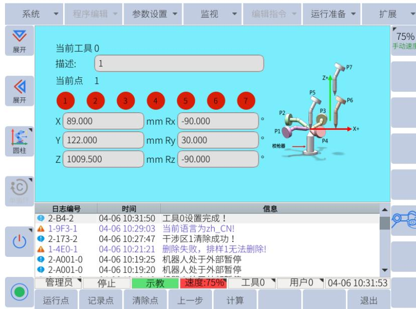
图 6-86: 七点法校准设定
