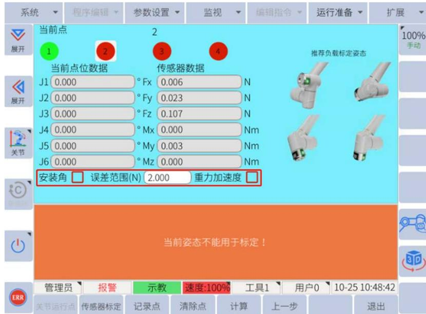
图6-44: 安装角和重力加速度
