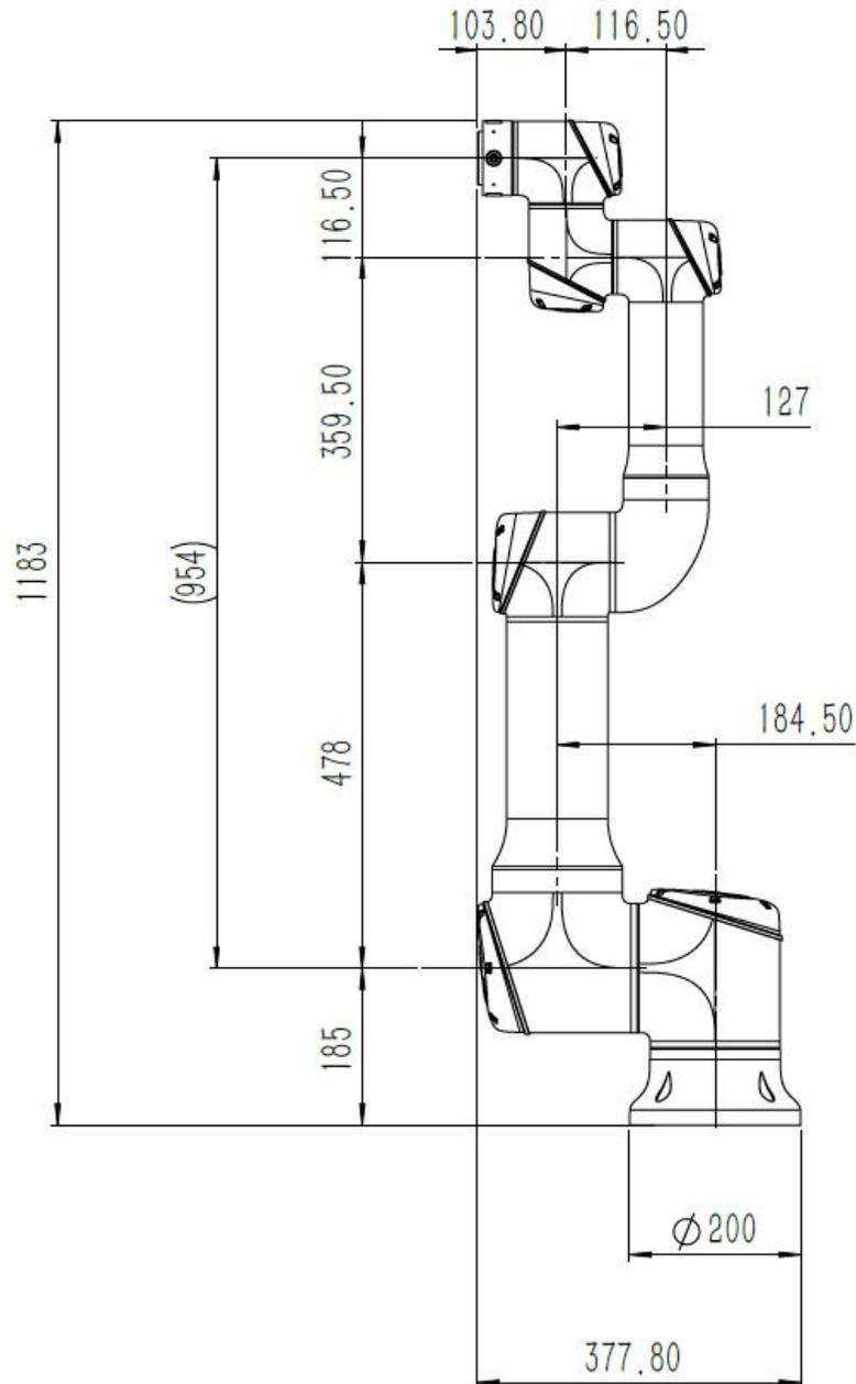
图 3-3 : EC616 机器人的机械尺寸图，单位为 mm
