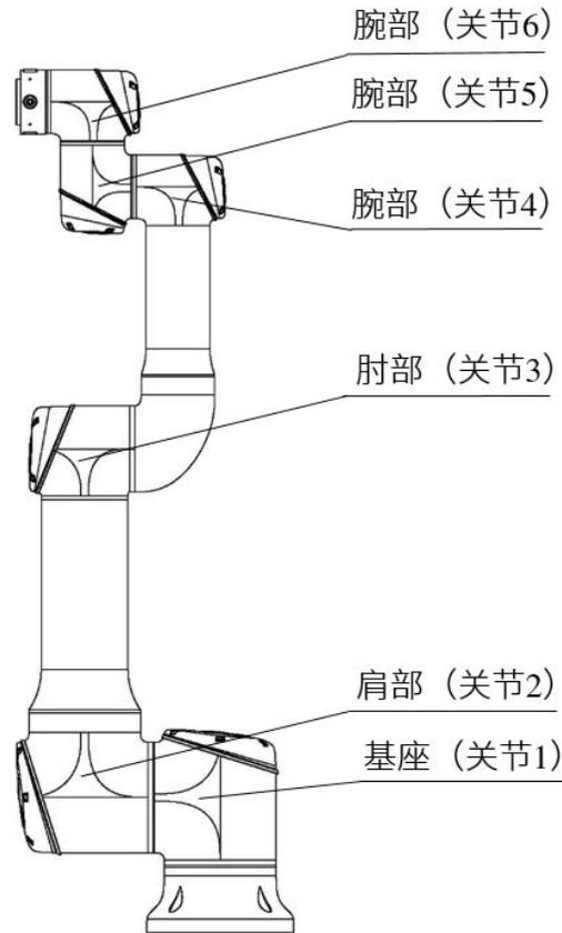
图 3-2：EC616 机器人关节
