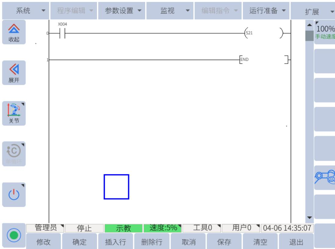
图 10-9：清除碰撞报警的 PLC 示例
