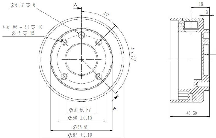
图 3-5：机器人工具法兰的机械尺寸，单位为 mm
