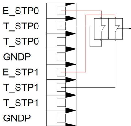
图 7-6: 连接外部紧急停止按钮
