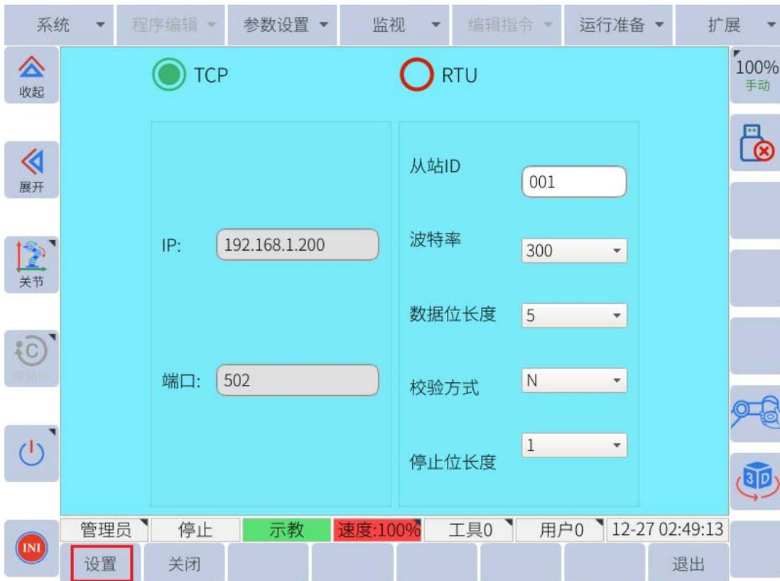
**图 8-1 : Modbus 配置界面**
