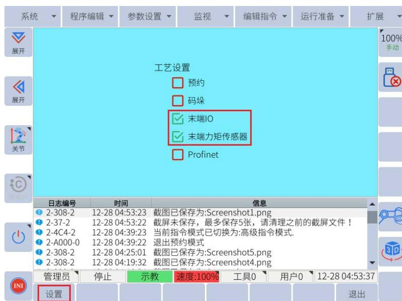
图 6-26: 勾选“末端IO”与“末端力矩传感器”
