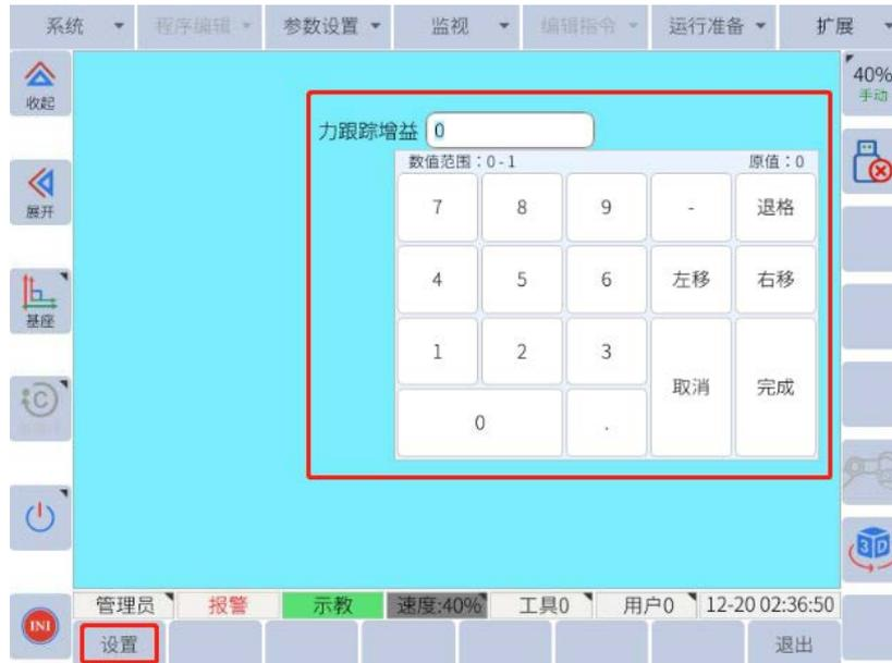
图 6-29: 力控参数设置界面
