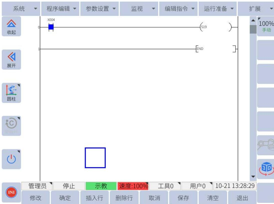
图 10-7：启动停止后自动恢复的 PLC 示例
