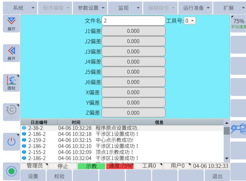
图 6-95：零点校验
