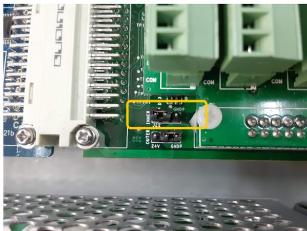
图 7-13：用于配置数字输入的跳线 j22
