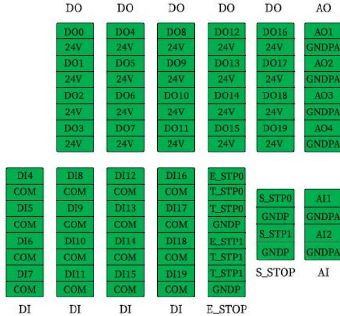
图 7-2：控制箱内部电气接口布局
