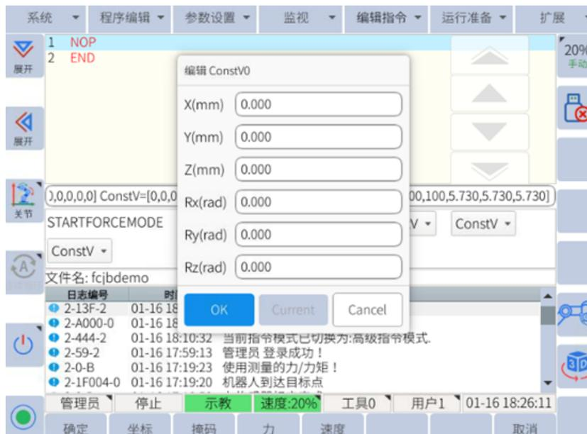
图 6-49: 力控坐标系的参数设置
