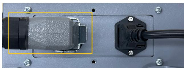
图 5-3：机器人线缆与控制箱的连接
