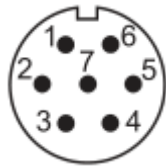
图 28 EtherCAT 调试口定义
