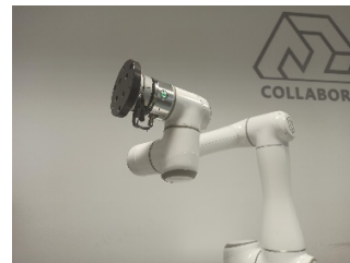
图 6-38: 负载安装完成
