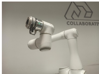
图 6-37: 力传感器末端
