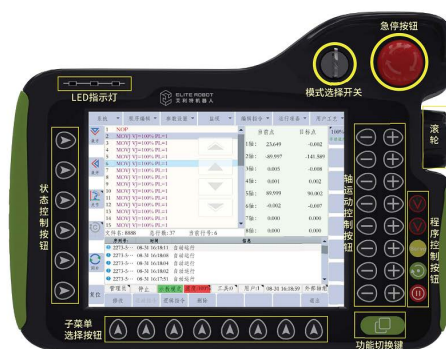
图 6-57: 示教器布局（正面）
