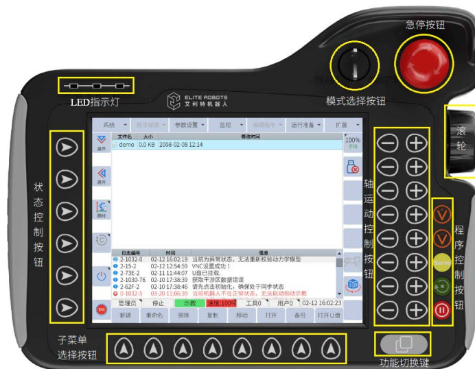
图 3-11：示教器布局（正面）
