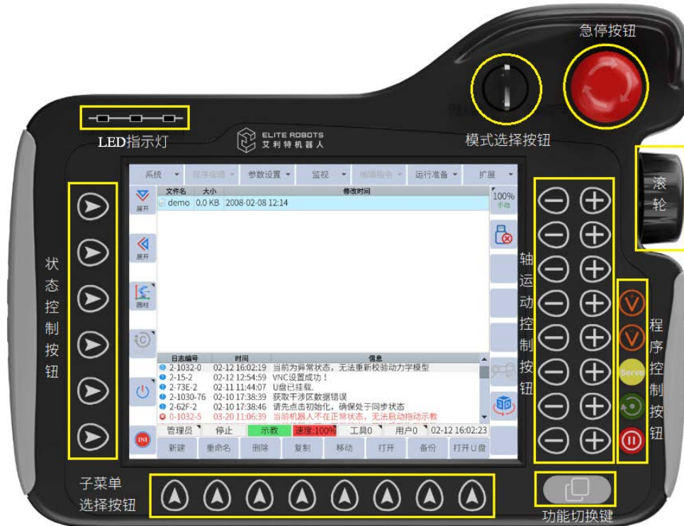
图 6-1：示教器布局（正面）
