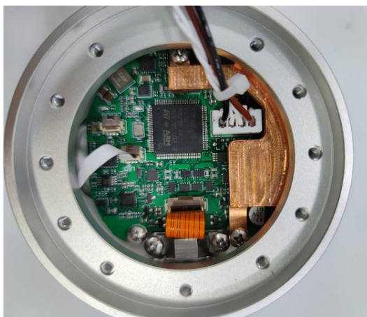
图 3-17 连接手腕 3 关节和末端法兰的电线
