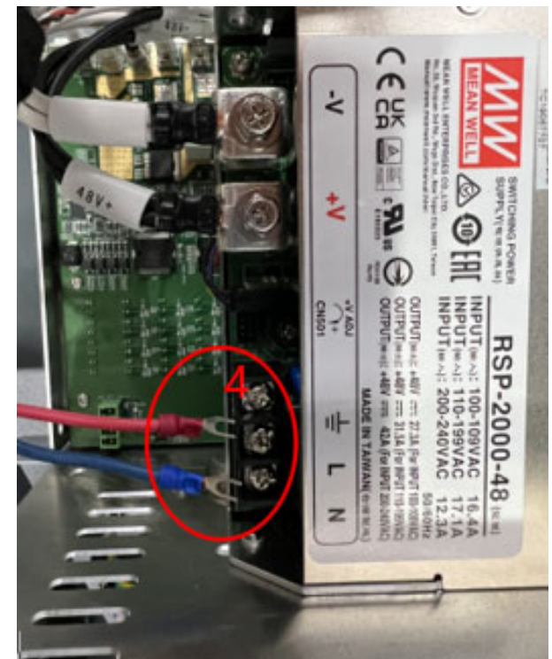
图 3-26 控制柜上的电源连接线位置
