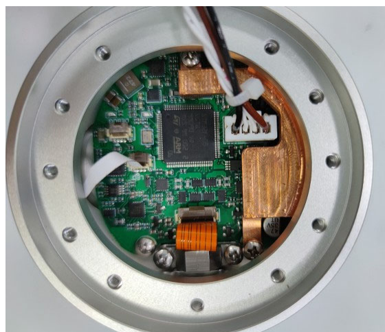
图 3-17 连接手腕 3 关节和末端法兰的电线
