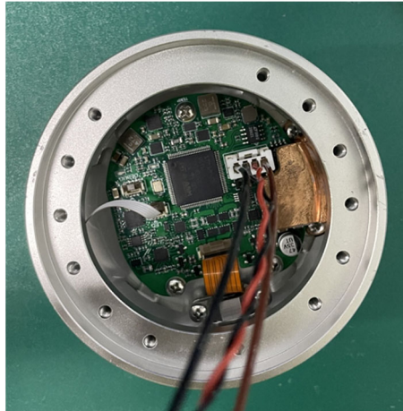
图 3-17 连接手腕 3 关节和末端法兰的电线
