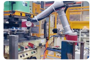
排气系统冲压搬运
