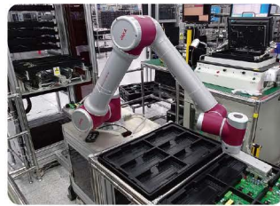
通讯电路板分类测试
