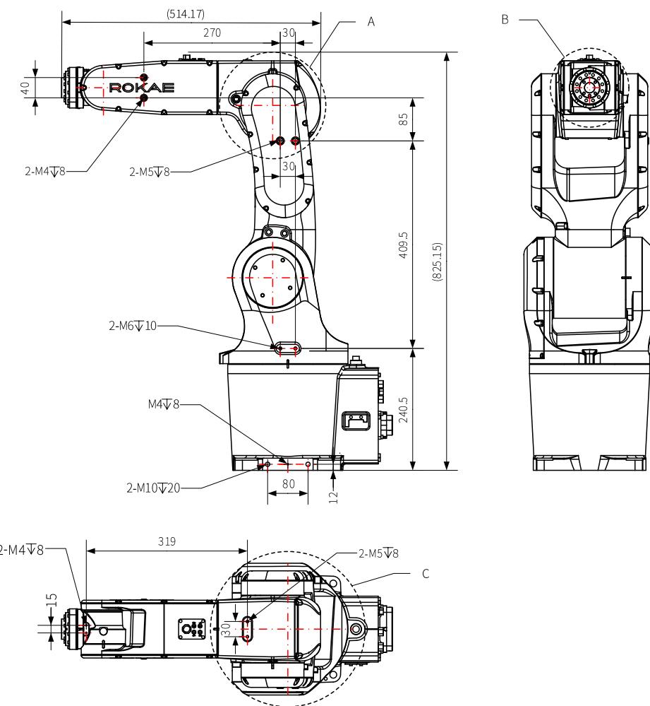
图 15 XB7 外形尺寸及机械接口图
