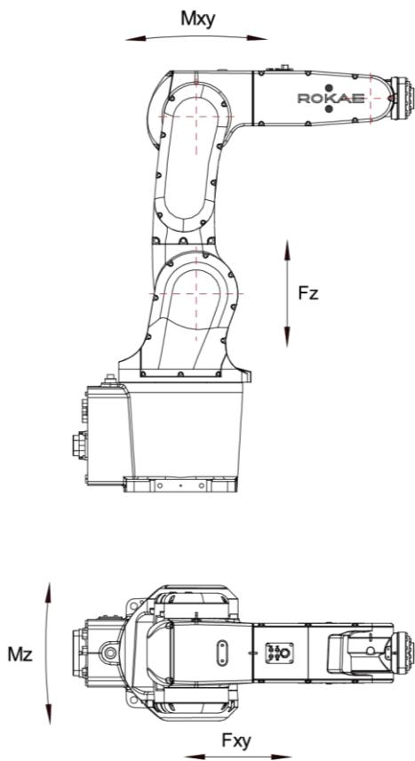
图 34 机器人支反力图
