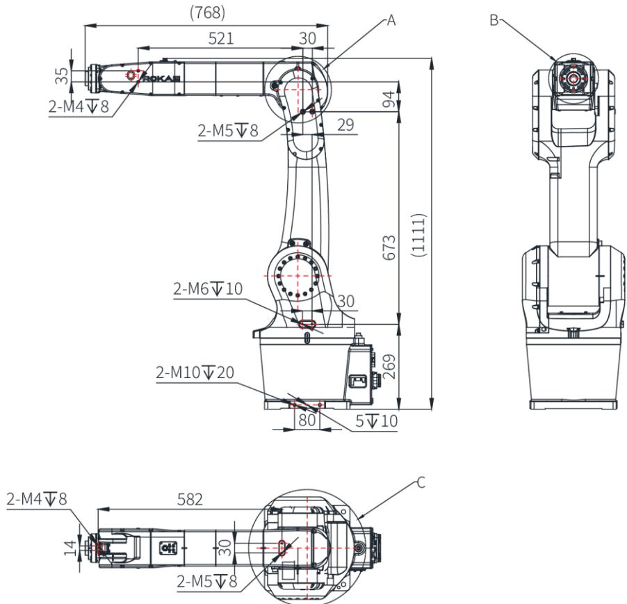
图 20 XB7XLh 外形尺寸及机械接口图
