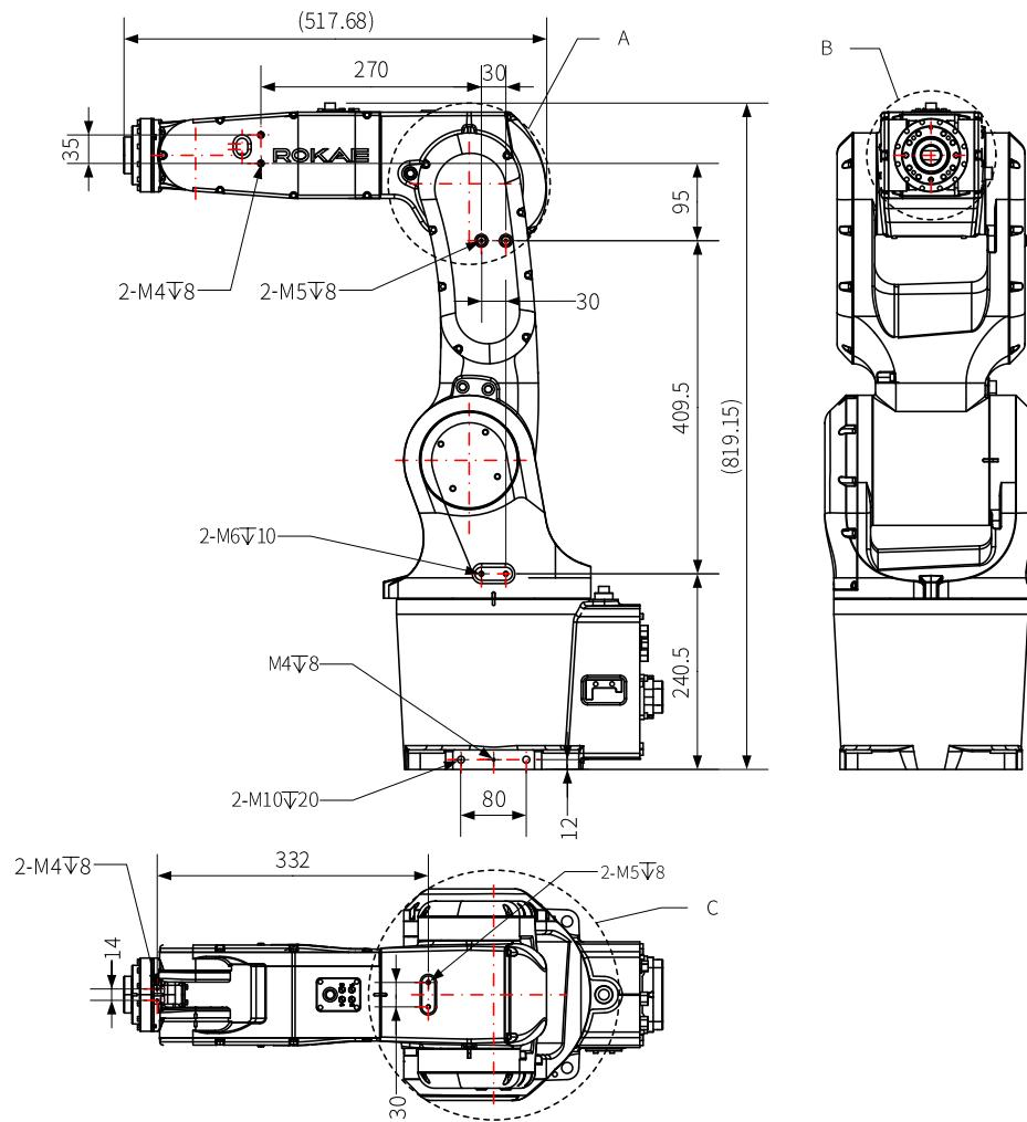
图 16 XB7h 外形尺寸及机械接口图
