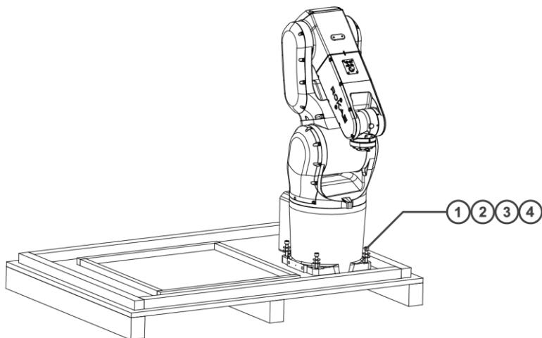
图 25 机器人本体拆箱图
