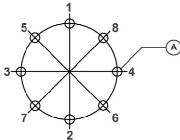
图 47 螺钉拧紧示意图
