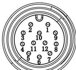
图 37 IO 接头引脚定义图
