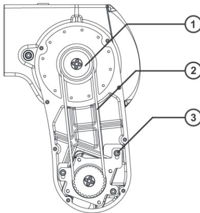
图 49 同步带维护
