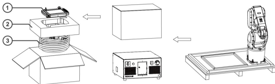
图 24 控制柜及示教器纸箱拆箱图
