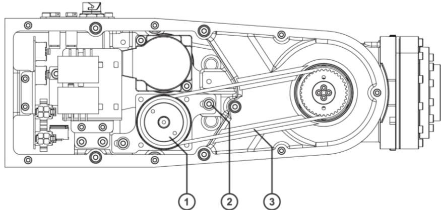
图 51 同步带维护
