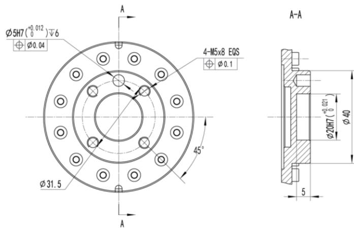
图 21 标准手腕输出法兰图
