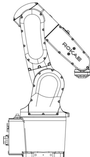
图 26 机器人运输角度
