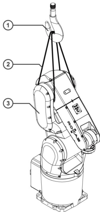
图 28 机器人吊装搬运
