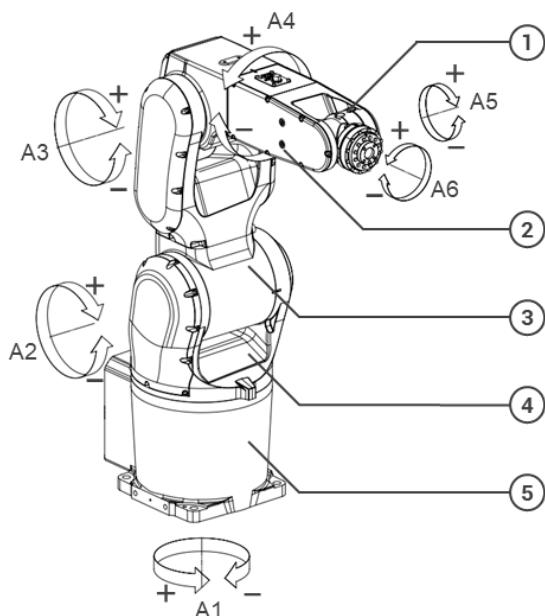
图 3 机器人各轴运动方向
