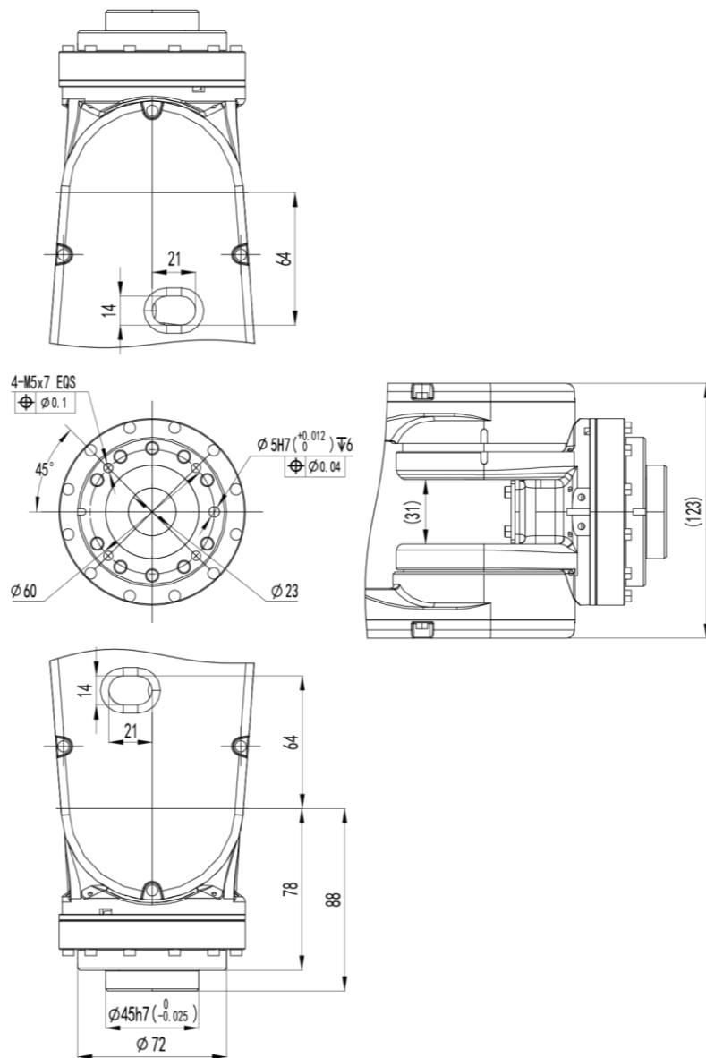
图 22 中空手腕输出法兰图
