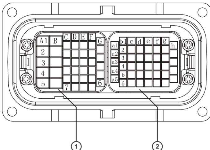
图 35 机器人本体侧端口定义图
