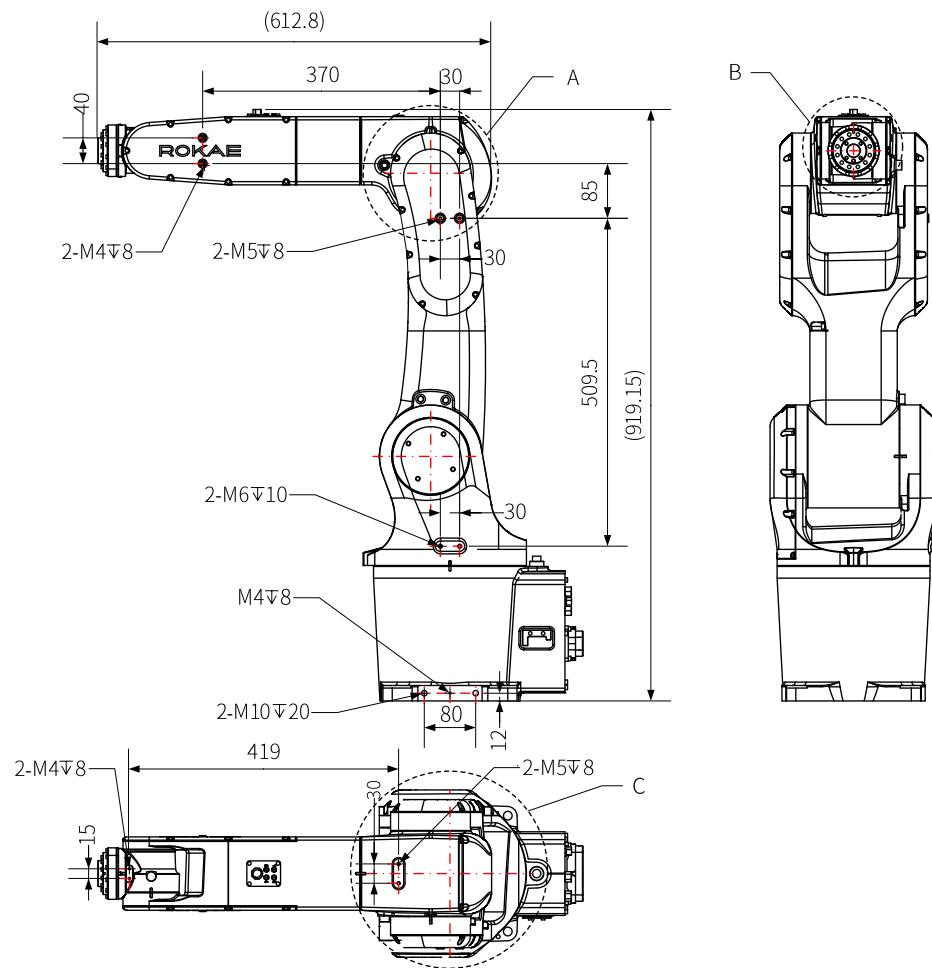
图 17 XB7L 外形尺寸及机械接口图
