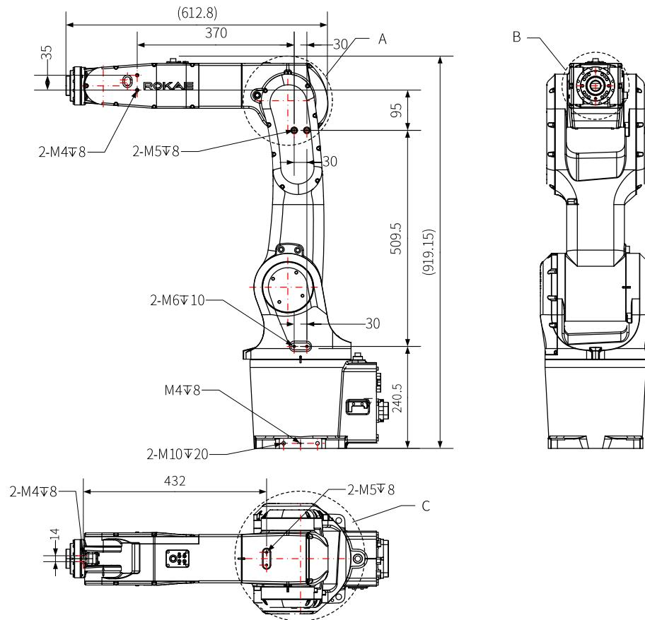
图 18 XB7Lh 外形尺寸及机械接口图
