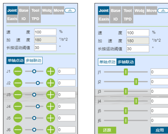
图表 3.6-2 单轴点动和多轴联动示意图
