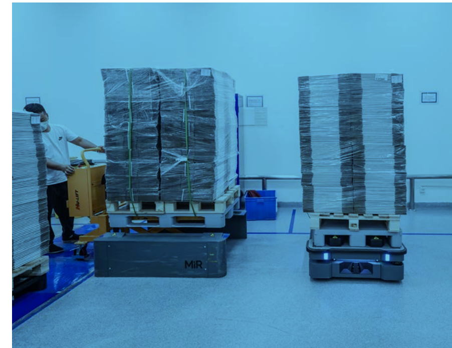
Novo Nordisk 使用配备了 MiR Lifts 的 MiR500 机器人，可自动将托盘从停靠区运输到仓库。
