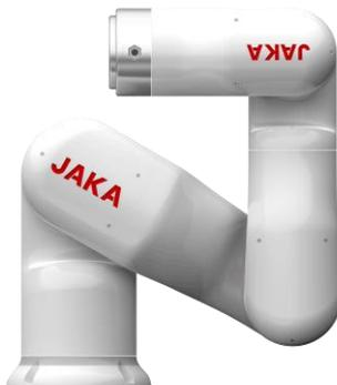
JAKA 全系列协作机器人开创性地采用了移动智能终端加 APP 的控制模式与机器人本体进行连接，一台移动终端可以对应数台机器人本体。同时，操作人员无需掌握专业编程语言，只需手动引导机器人即可完成编程，人机协作更加从容，极大地提高了工作效率。
