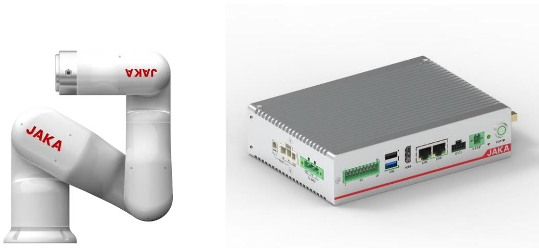
图 3-2 JAKA Mini 系列机器人与 MiniCab 控制器实物图
