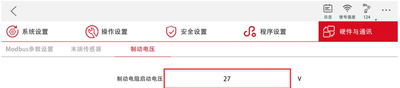
图 6-12 制动电压设置路径
