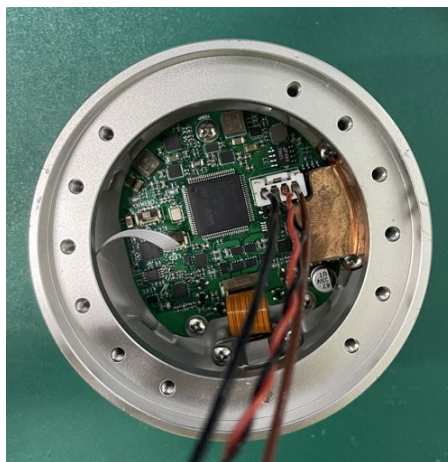
图 3-17 连接手腕 3 关节和末端法兰的电线
