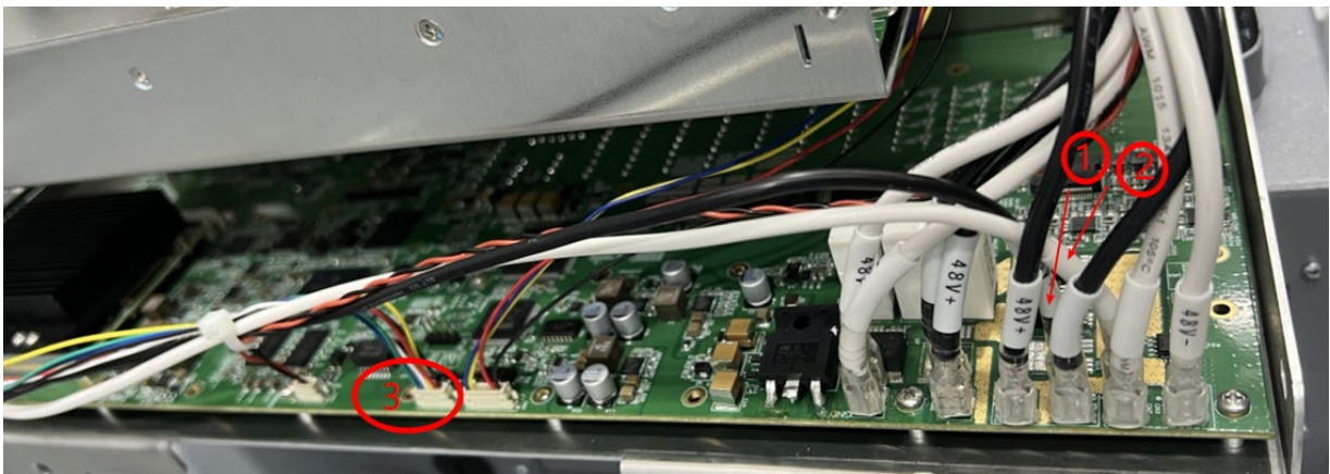
图 3-29 刹车板到 Safe IO 的线缆位置
