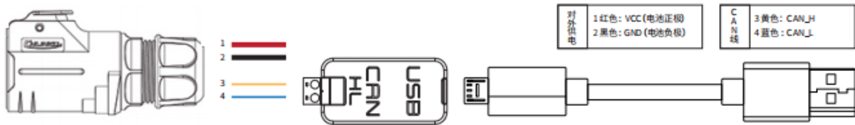
图3.4CAN线连接示意图
